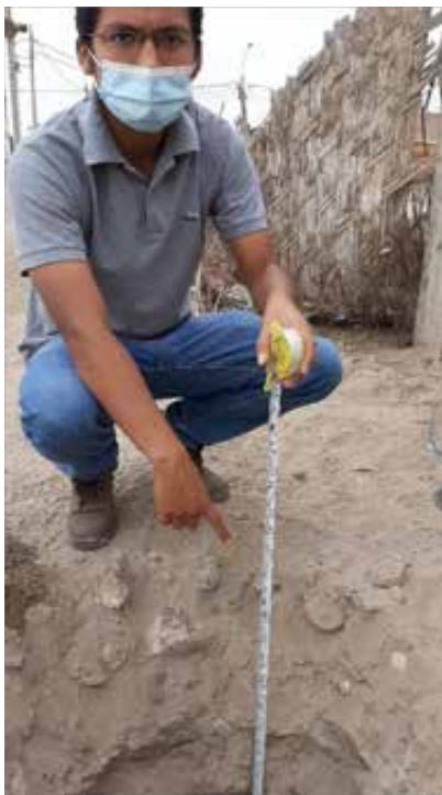
FOTO N° 2 INVESTIGADOR REALIZANDO CALICATA PARA RECONOCER LAS CARACTERISTICAS DEL TERRENO
