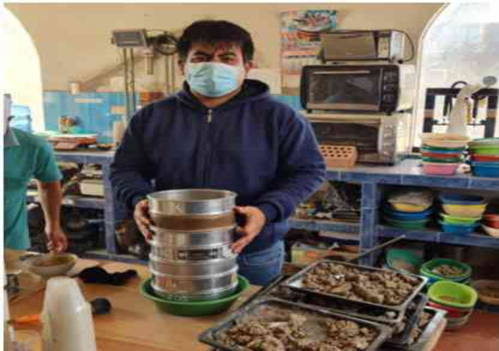
Foto 05. Tamizado de la muestra del suelo
