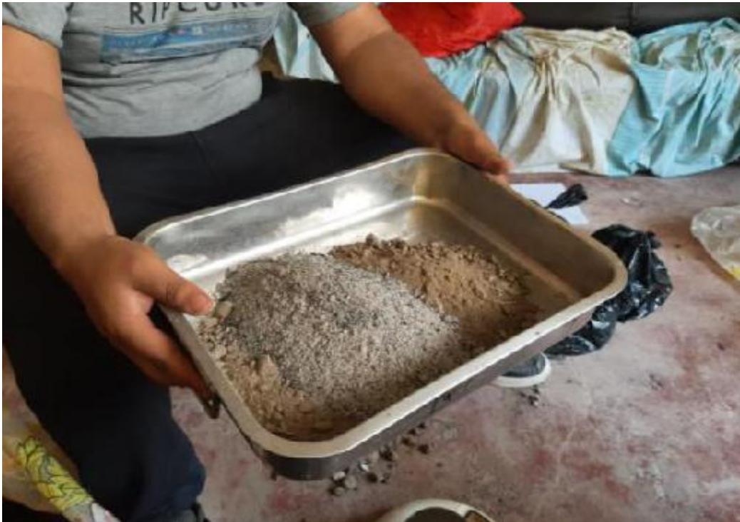
Foto10. Muestras de cenizas de cascara de café y del suelo preparadas para la posterior mezcla
