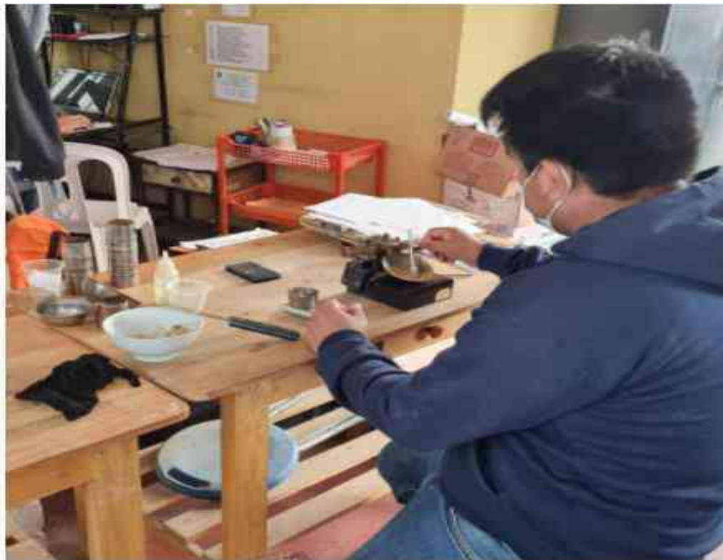
Foto 06. Límites de Plasticidad de la muestra del suelo
