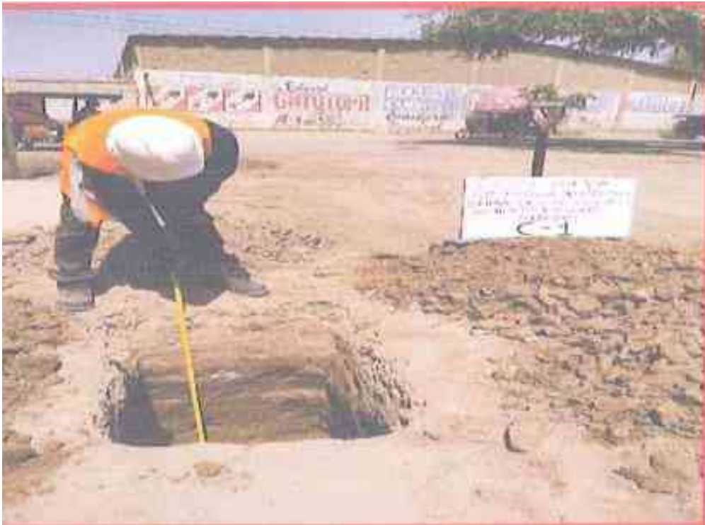
Foto 01. Calicata N° 1 para muestra de suelo
