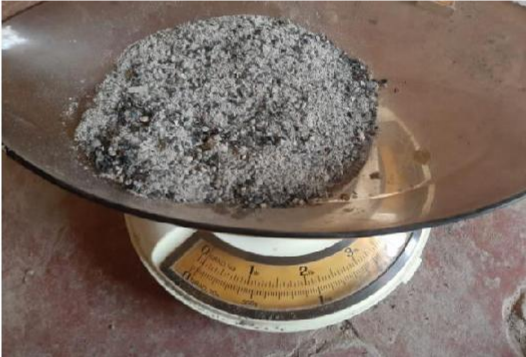
Foto 07. Peso de la muestra de las cenizas de la cascara de café
