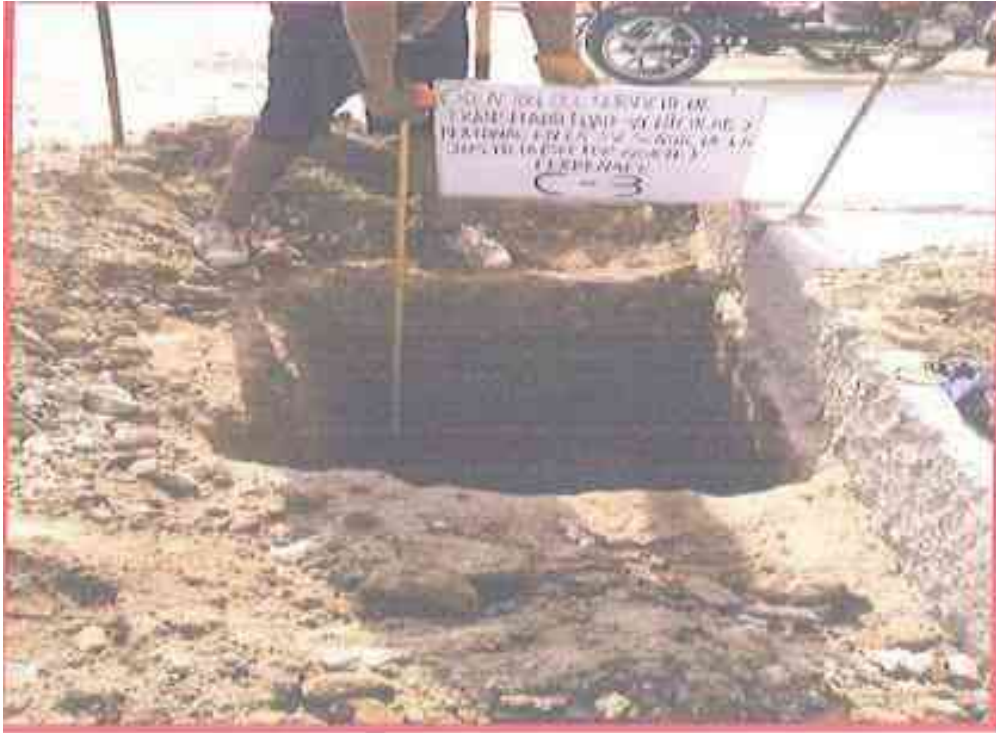
Foto 03. Calicata N° 3 para muestra de suelo
