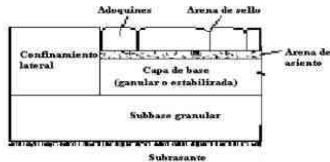
Figura 5. Estructura de un pavimento articulado Fuente: Mocondino (2020)
