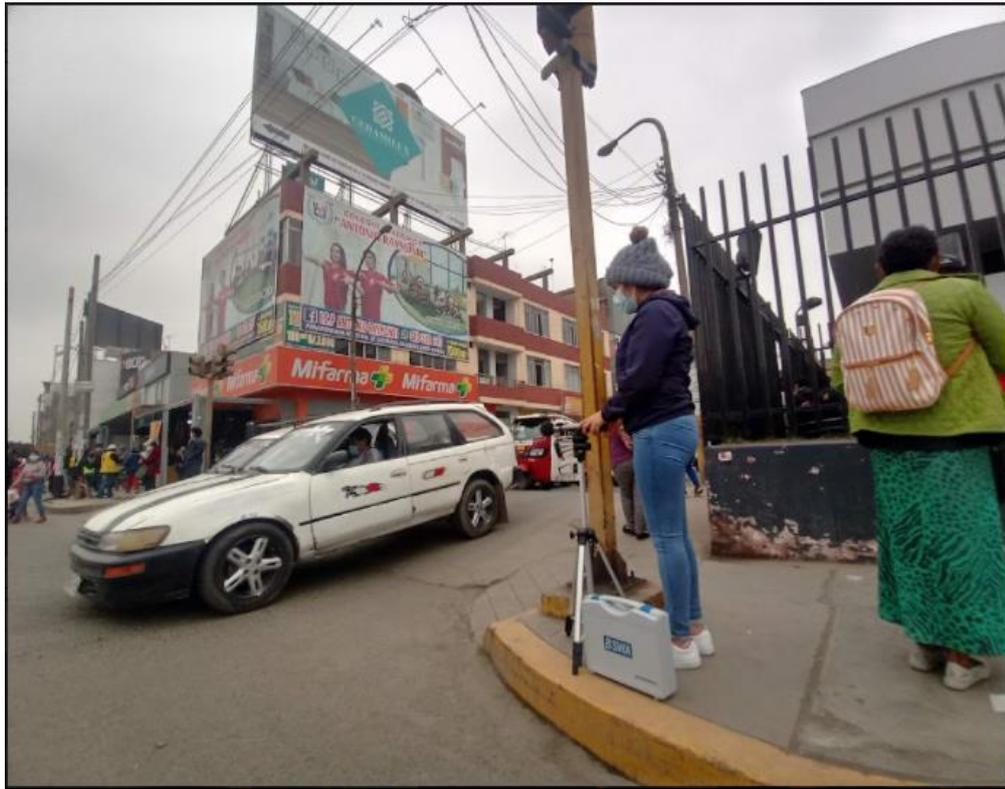
**Figura 32.** Medición de ruido realizado en la Av. Santa Lucía / Av. Puente Piedra
