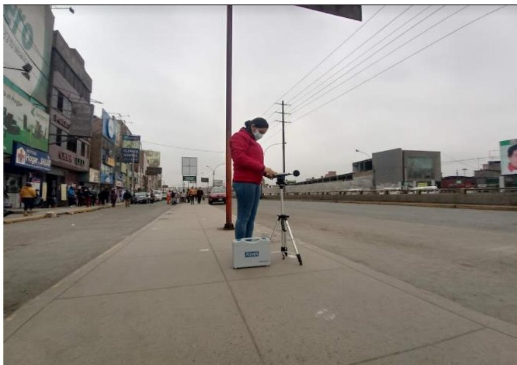
*Figura 28.* Instalación inicial del equipo de monitoreo
