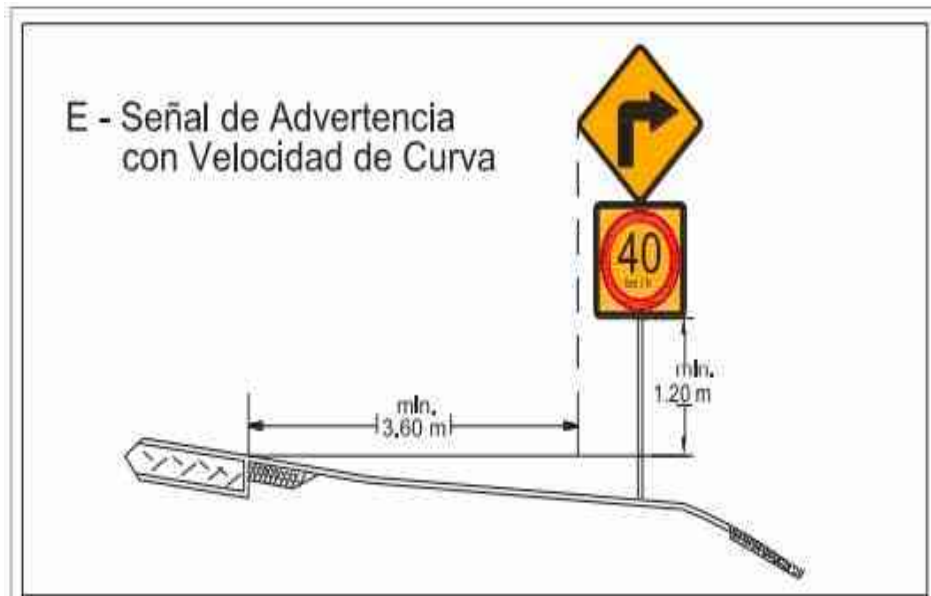
Figura 21. Señal de Advertencia con Velocidad de Curva
