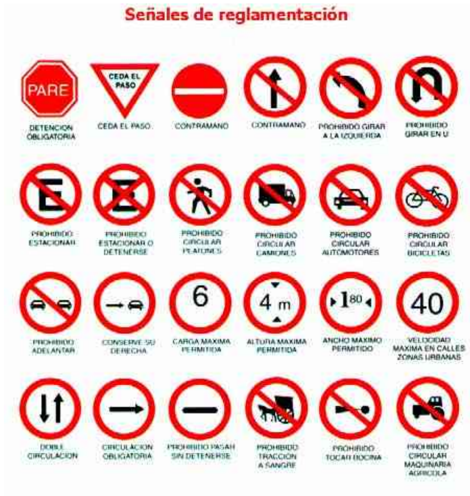
Figura 7. Señales de Reglamentación
