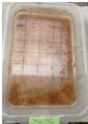
Figura 10 Cuba-C 3 el solvente es turbio y el olor es fétido
