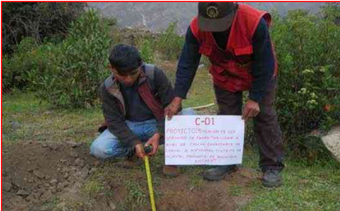
Personal controla la Calicata N° 01, Para Toma de Muestra con Fines de análisis de Mecánica de Suelos.
