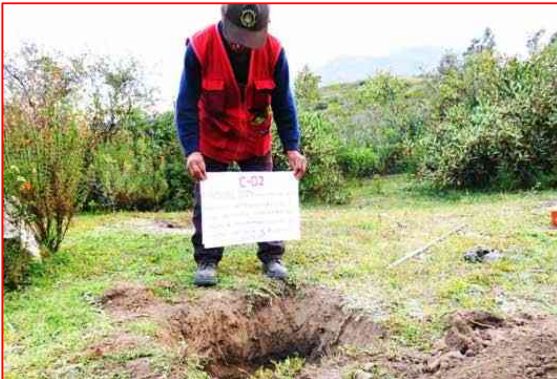
Personal examina el muestreo de la Calicata N° 02, Para el Estudio de Mecánica de Suelos.
