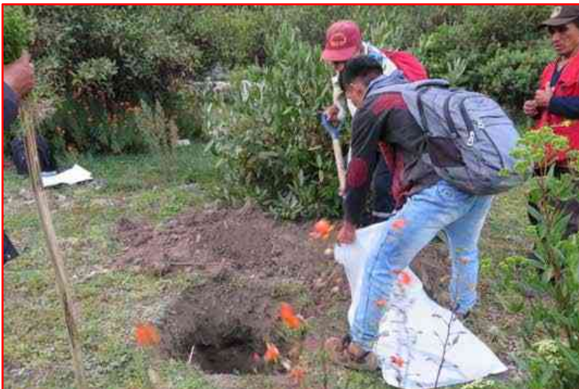
Personal controla el muestreo de la Calicata N° 01, Para el análisis de Mecánica de Suelos.
