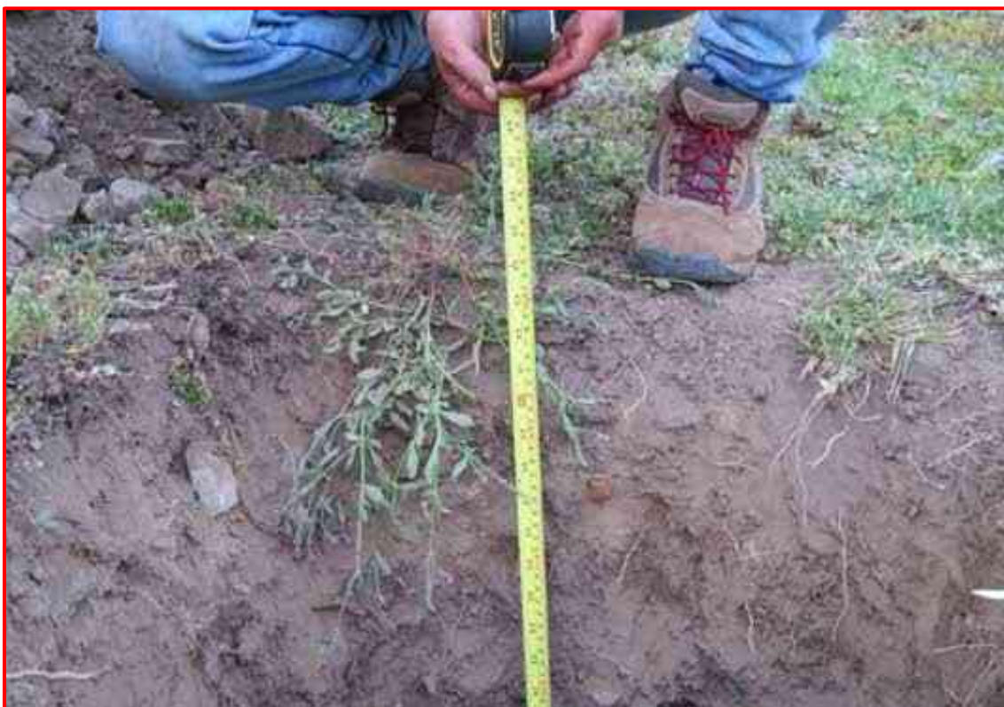
El personal midiendo la Calicata h=1.6 m, Para Toma de Muestra con Fines de análisis de Mecánica de Suelos.
