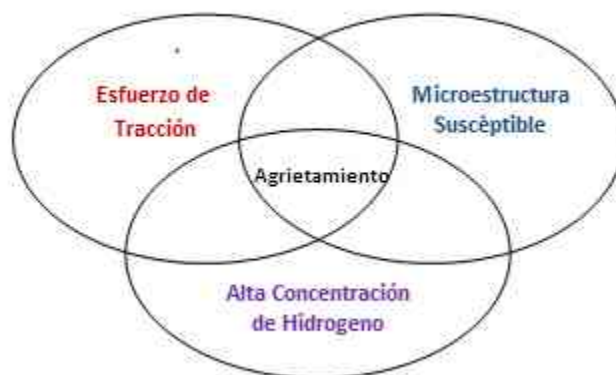
Figura 4. Sensibilidad en formación de fisuras en frío.
