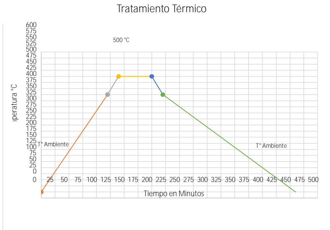
Figura 14. Grafica 500°C de tratamiento térmico.
