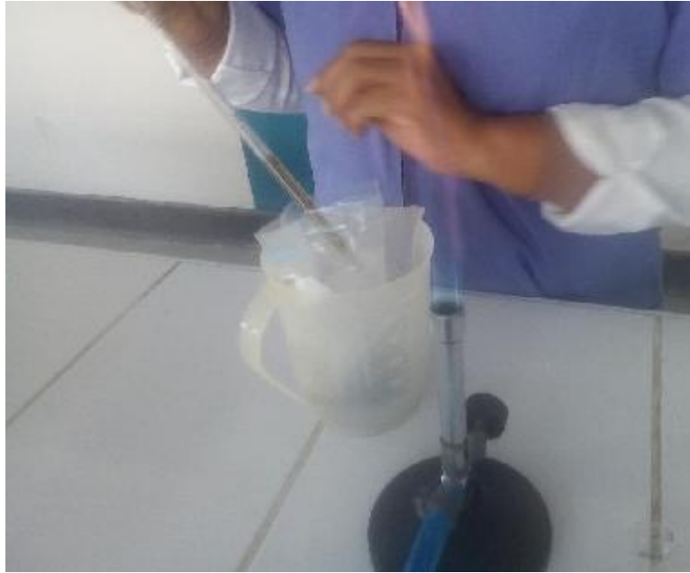
Figura 18. Extracción de la parte superior de los lodos
