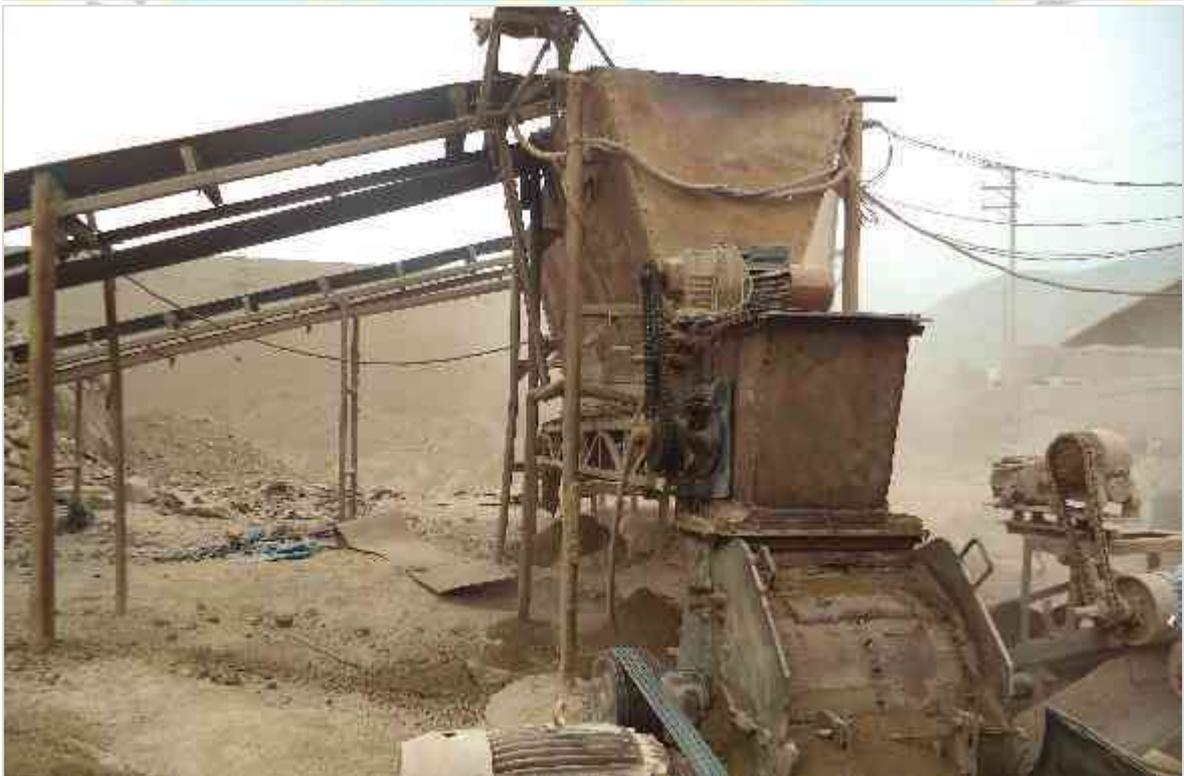
*Figura 22. Zarandeo de primera mezcla y mezclado en tolva.*
