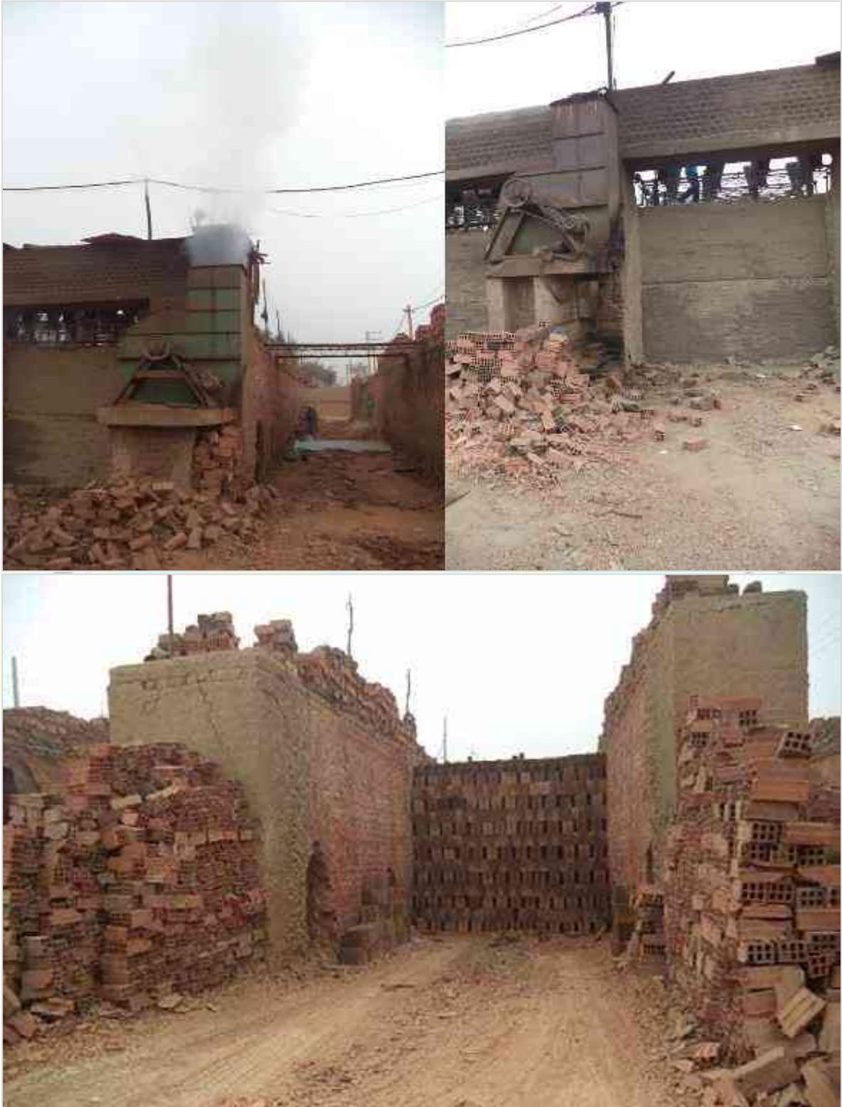
*Figura 24.* Horneado de ladrillos, enfriamiento y almacenamiento de ladrillos.
