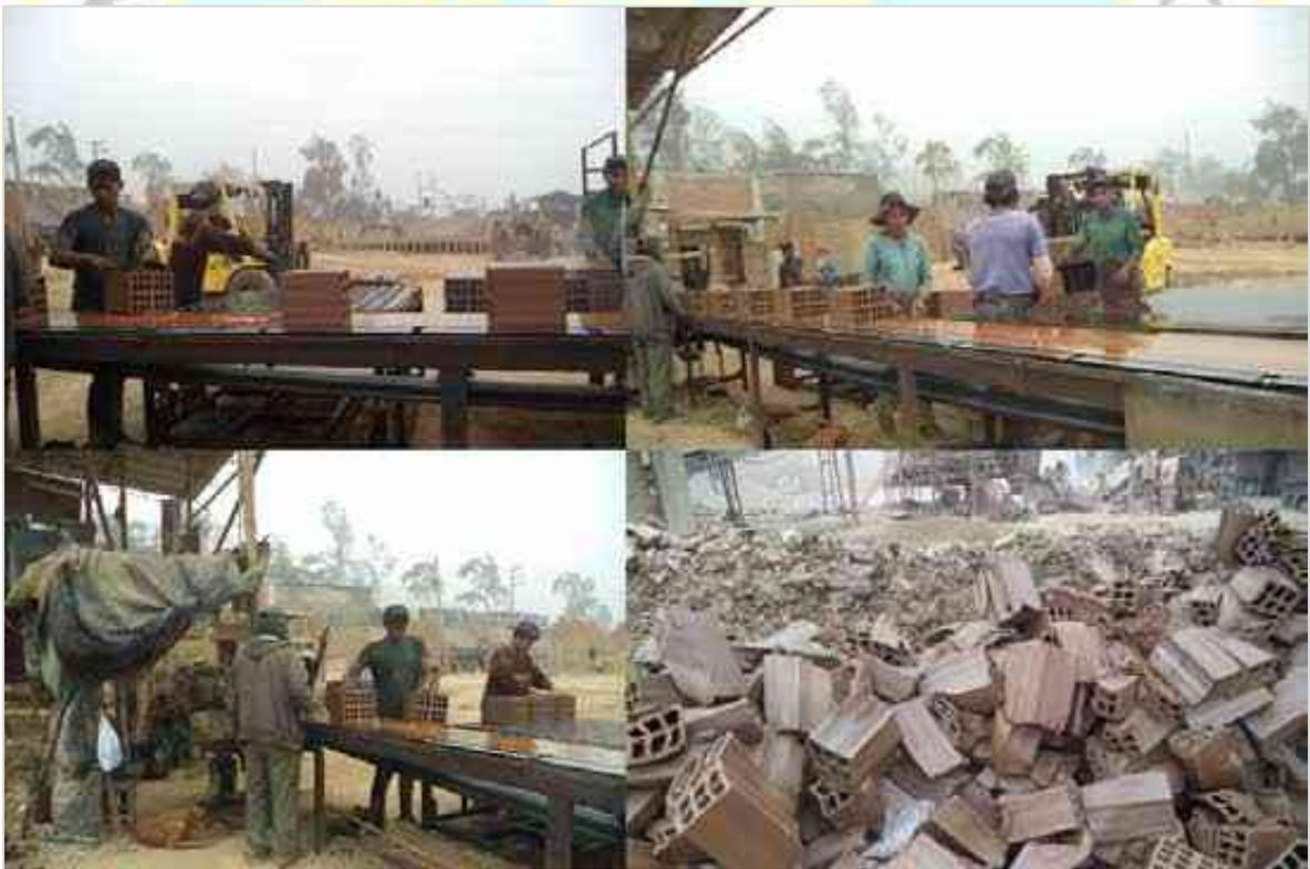
*Figura 23.* Mezclado en batea con agua, extrusión y moldeado, cortado y secado de ladrillos.
