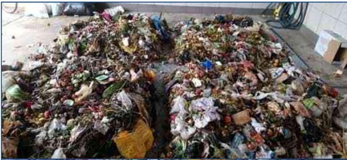
*Figura 20. Método de cuarteo ECRS 2016 MPH*
