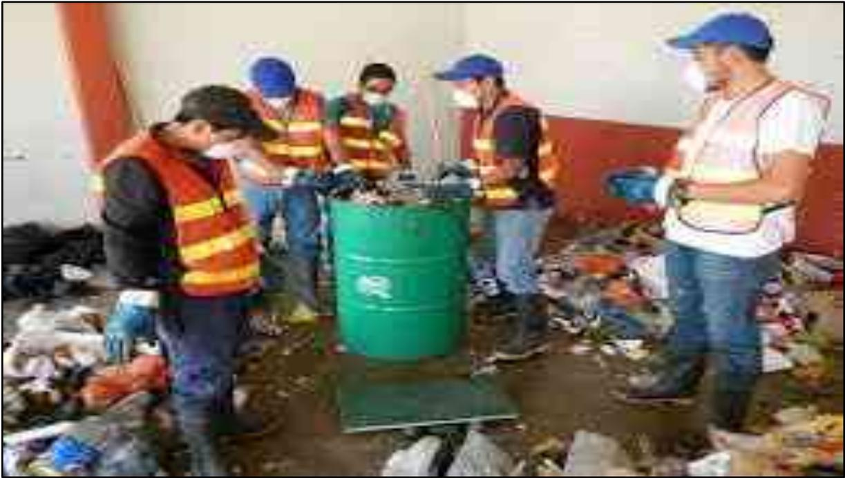
*Figura 1.* Determinación de masa volumen y densidad.
