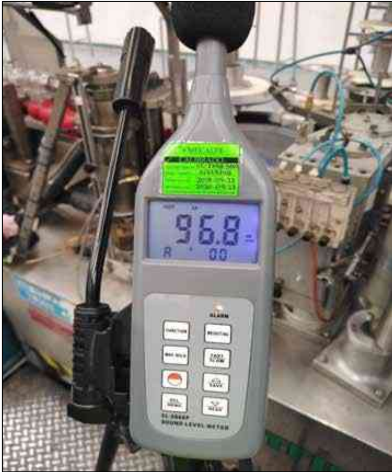
Figura 17. Monitoreo de ruido ocupacional en etiquetadora L2 y L3
