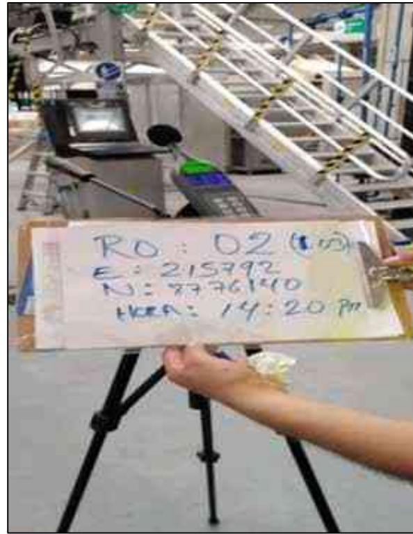
Figura 16. Monitoreo de ruido ocupacional en soplado línea 03
