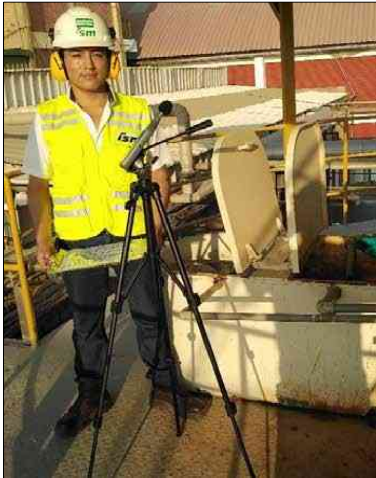
Figura 19. Monitoreo de ruido ocupacional en tanque reactor
