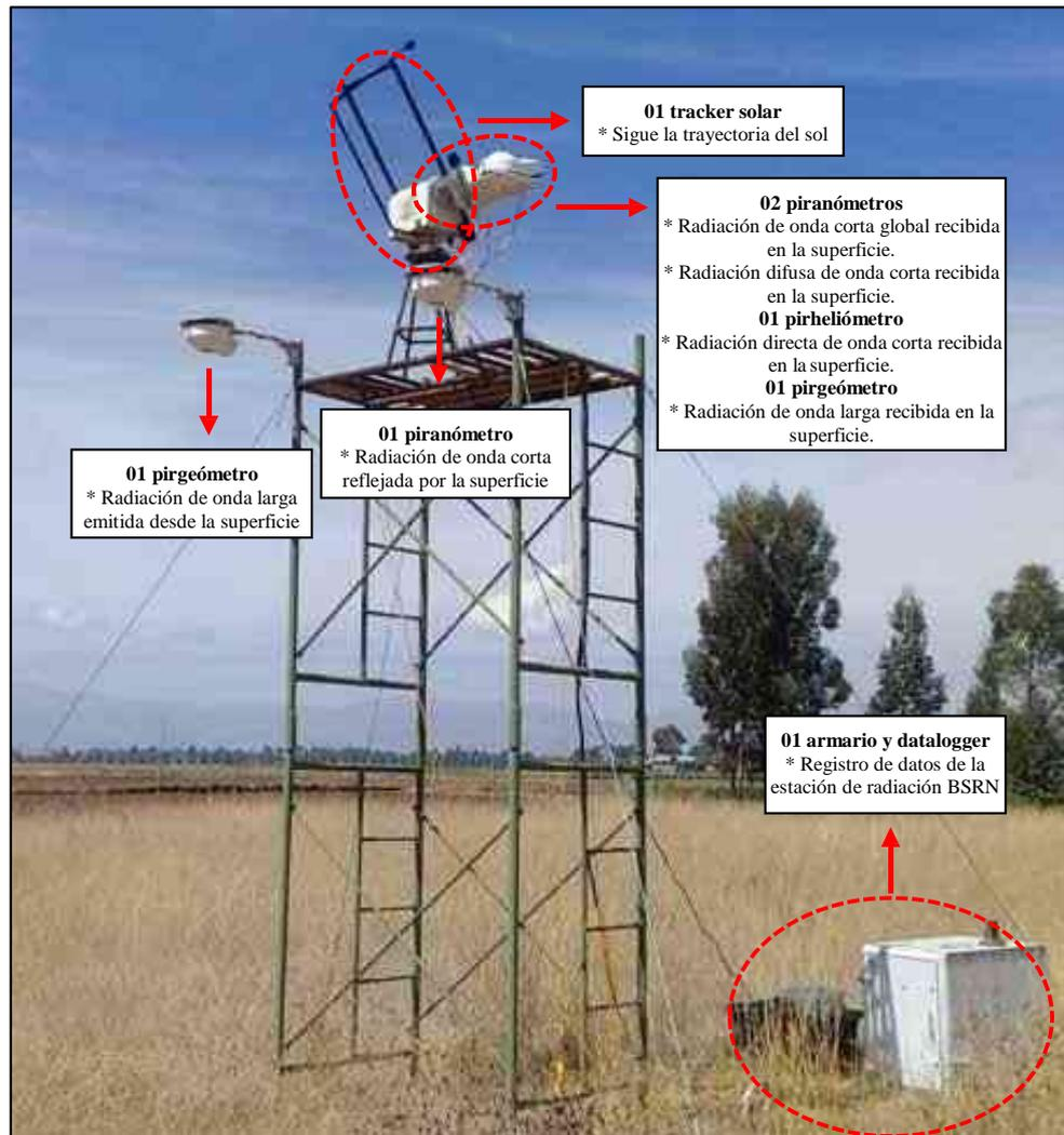
Figura 10. Estación de radiación BSRN en el Observatorio de Huancayo.
