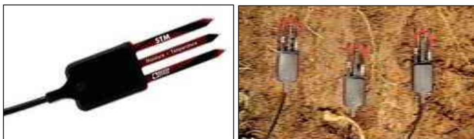
Figura 18. Sensor de contenido de agua y temperatura, Decagon 5TM.
