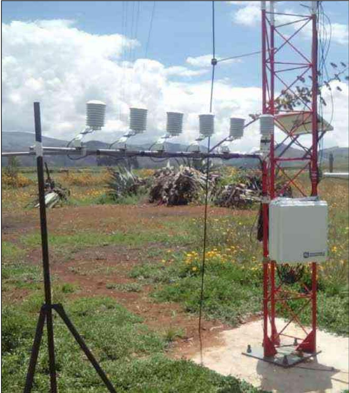
*Figura 85.* Termohigrómetros desplazados hasta el nivel 1 para su intercomparación.
