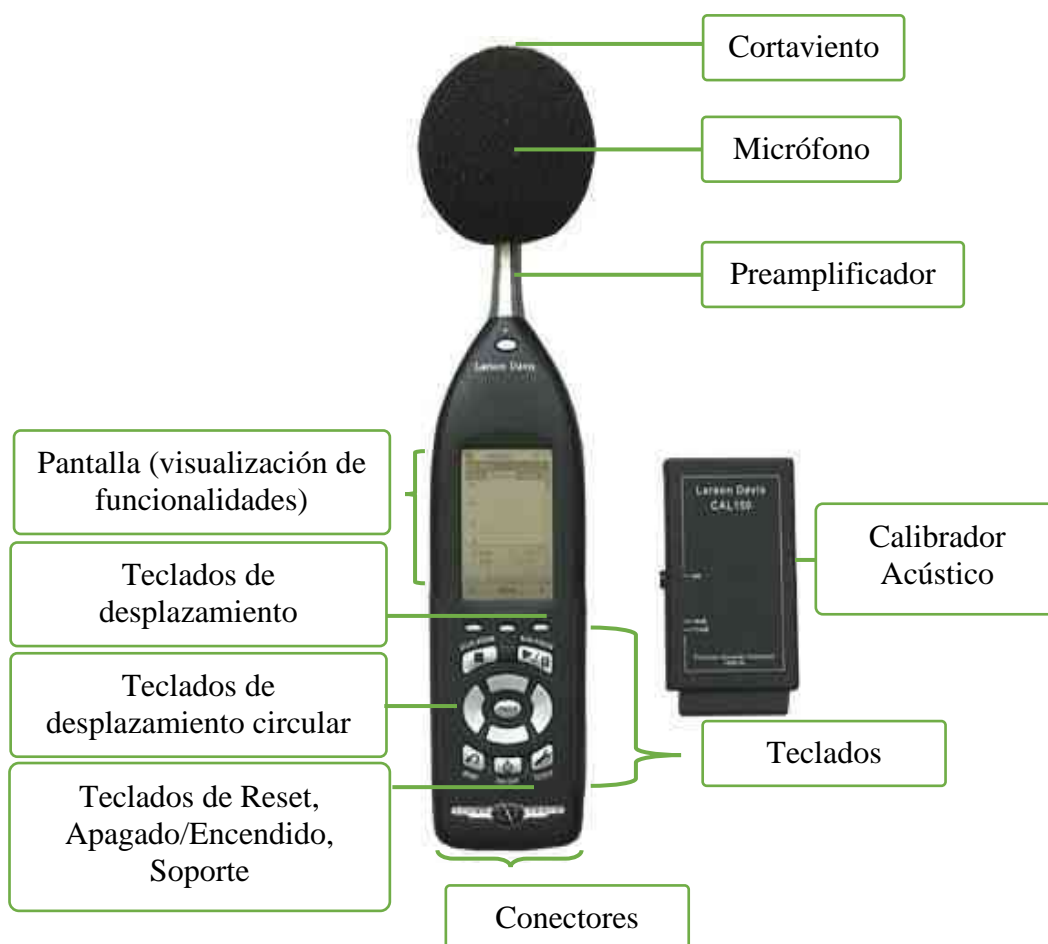
Figura 1. Componentes de un sonómetro
