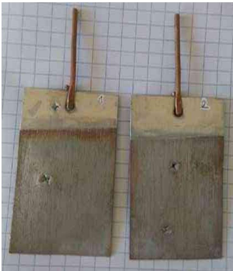
*Ilustración 17.* Recuperación de cobre en 2 horas, 1,5 V y separación de 1 cm (1) y 2 cm (2)
