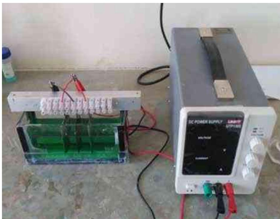
*Ilustración 7.*Equipos del proceso de electrodeposición
