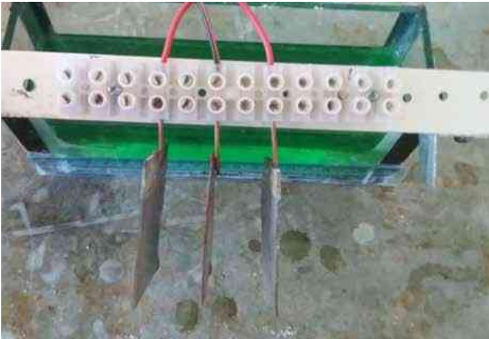
*Ilustración 16.*Cosecha de cátodos (separación de electrodos 2 cm)
