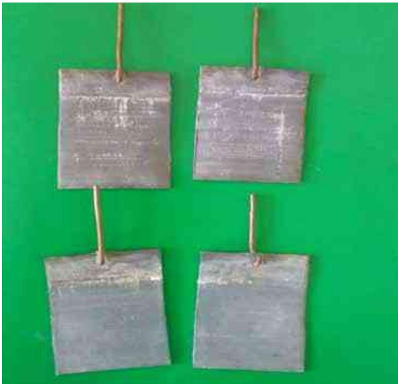
*Ilustración 10. Ánodos (aleación Pb-Sn)*
