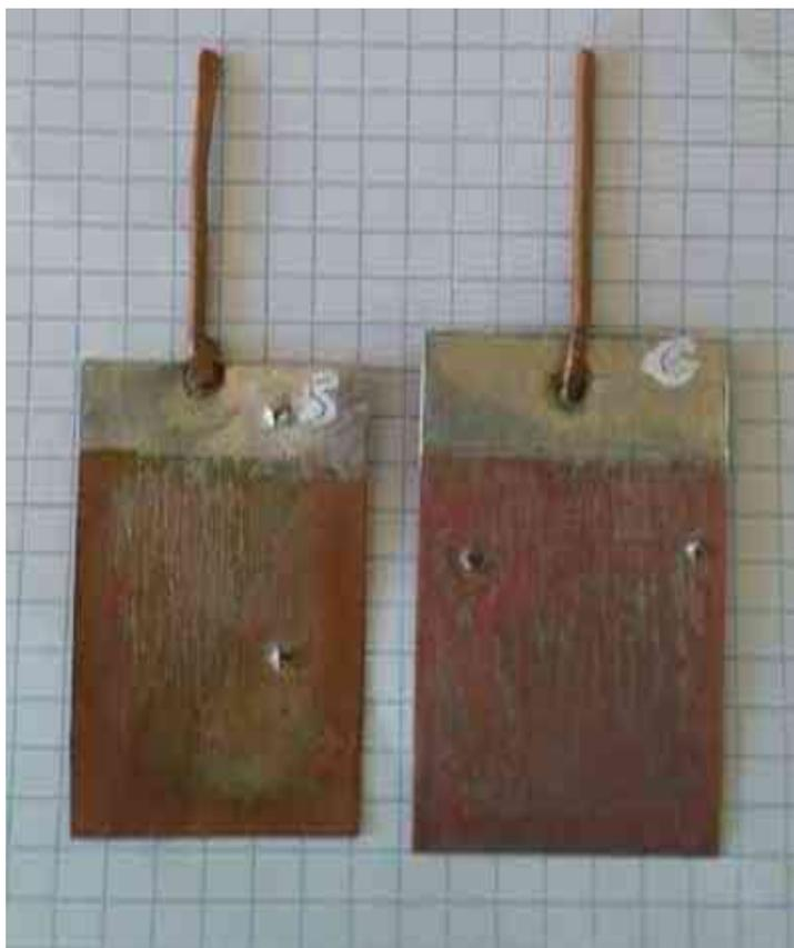
*Ilustración 19.* Recuperación de cobre en 3 horas, 1,5 V y separación de 1 cm (5) y 2 cm (6)
