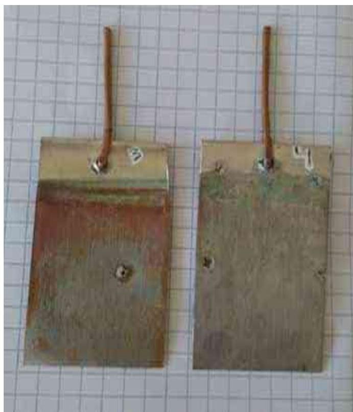
*Ilustración 18.* Recuperación de cobre en 2 horas, 1,8 V y separación de 1 cm (3) y 2 cm (4)
