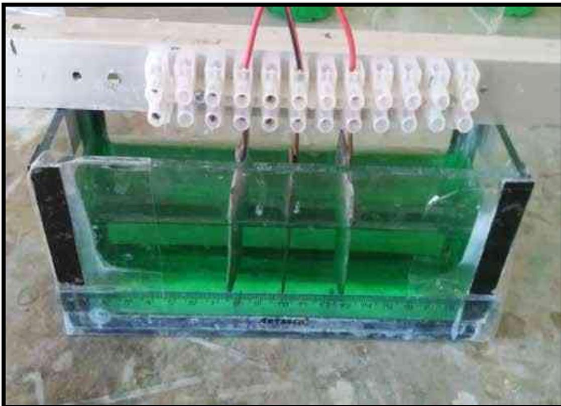
Ilustración 8. Configuración de la celda electrolítica.
