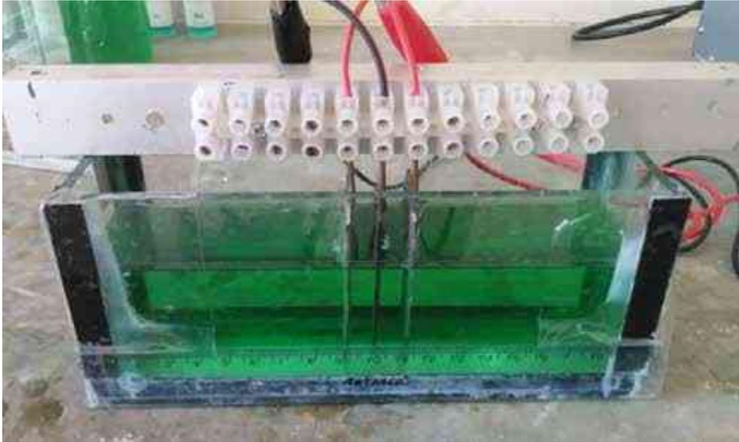
*Ilustración 13.*Proceso de electrodeposición 1 cm de distancia de electrodos
