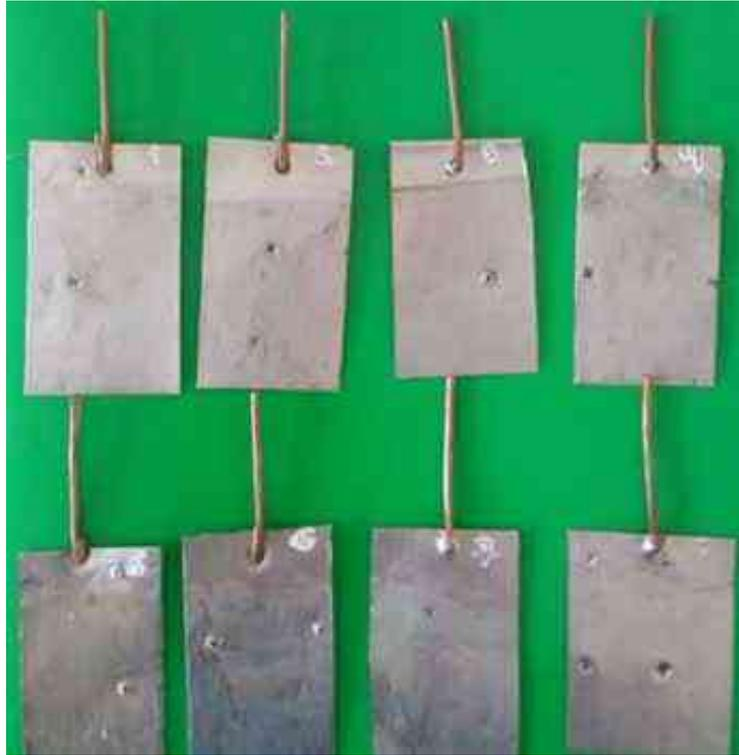
*Ilustración 11.* Cátodos (acero inoxidable AISI 316-L)
