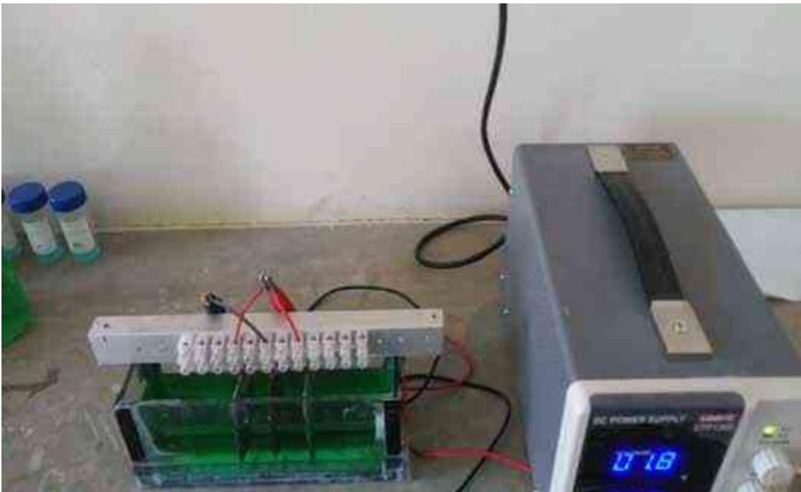
*Ilustración 14.*Proceso de electrodeposición 2 cm de distancia de electrodos
