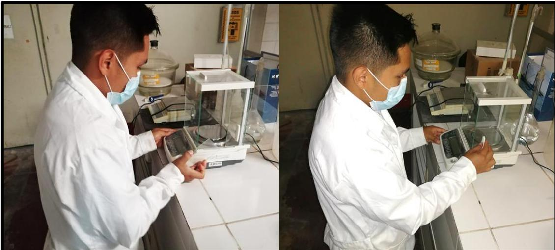
*Figura 58.* Pesaje de las placas receptoras
