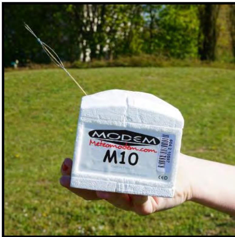
*Figura 9.* Radiosonda Meteomodem M10
