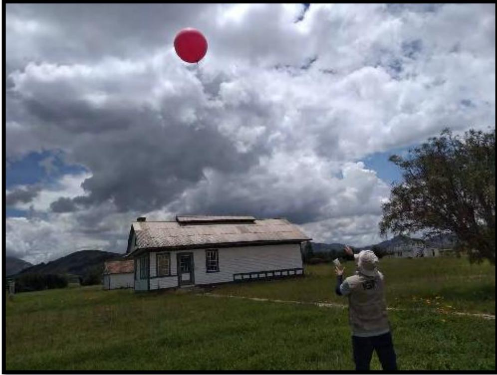
*Figura 35.* Lanzamiento de radiosonda en el observatorio de Huancayo
