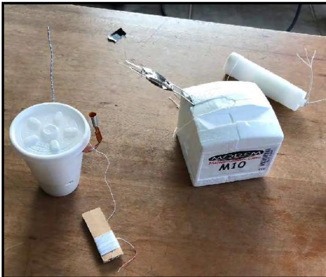
*Figura 10. Radiosondas Windsond (izquierda) y Meteomodem M10 (derecha)*
