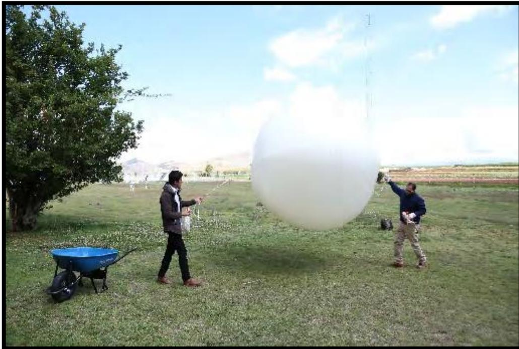
*Figura 36.* Preparación de un globo cautivo para su lanzamiento.
