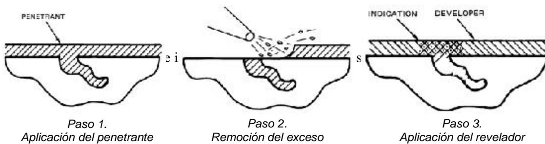
Figura 6. Proceso básico de inspección por tintes penetrantes.
