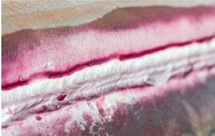
*Figura 3.* Inspección mediante tinte penetrantes visibles.
