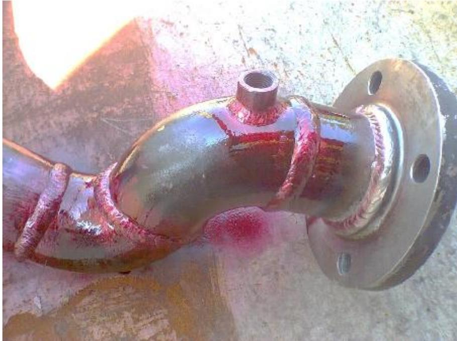
*Figura 1.* Inspección mediante tinte penetrantes a tuberías.
