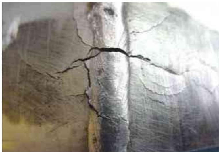
*Figura 15.* Fotografía de grieta de corrosión bajo tensión.
