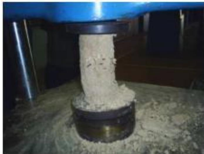
**Figura 5:** *Prueba de resistencia a la compresión*
