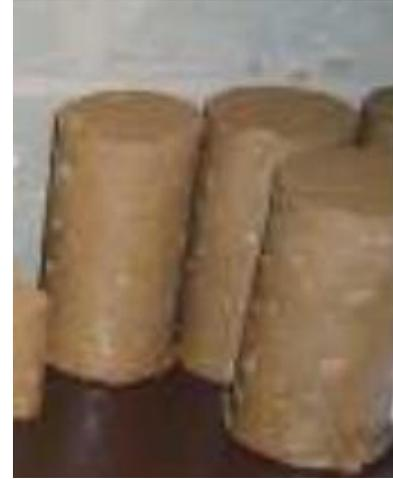
**Figura 4:** *Probetas lodo-cemento*
