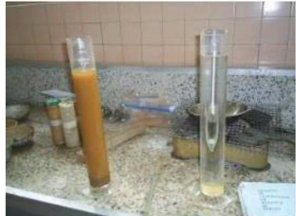
Ensayo de hidrómetro
