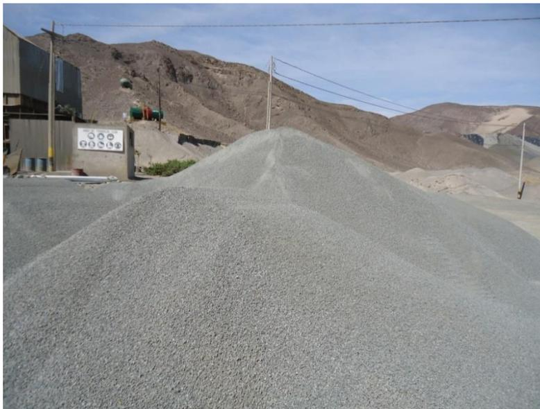
**Figura N° 6:** Mineral triturado con diámetro menor a 1/2 “
