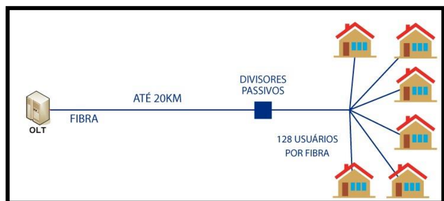
Figura 17: Arquitectura básica de una red GPON
