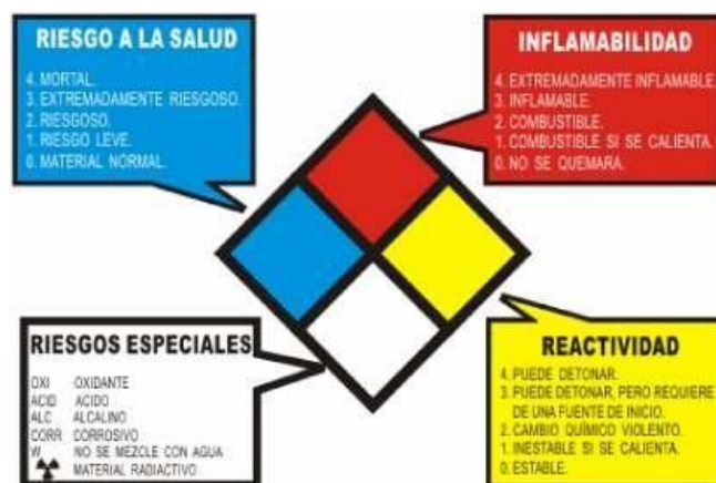
Figura 6: Rombo de seguridad
