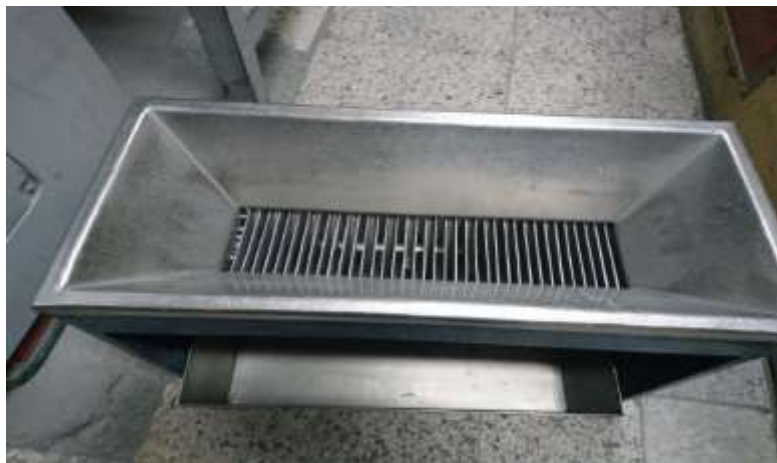
Figura 13 Cuarteador Jones para Muestras Solidas.
