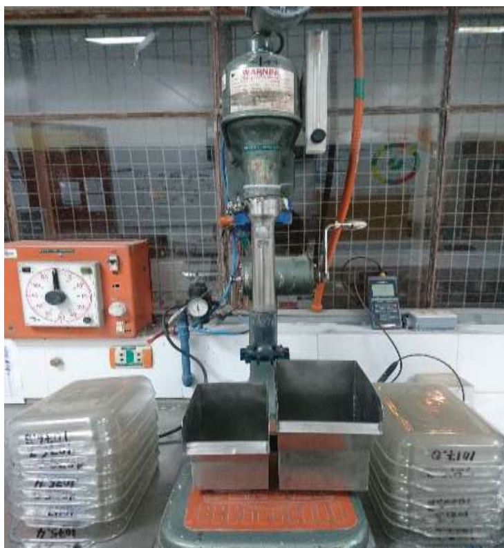
Figura 20 Celda de Flotación Denver Laboratorio Metalúrgico
