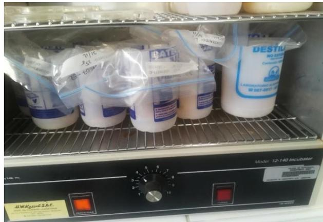
**ENRIQUECIMIENTO:** TUBOS DE IZQUIERDA CON CALDO (SC) Y (RV) ANTES DE INOCULAR Y LOS DE LA DERECHA DESPUES DE 24 HORAS A 37 °C EN ESTUFA.
