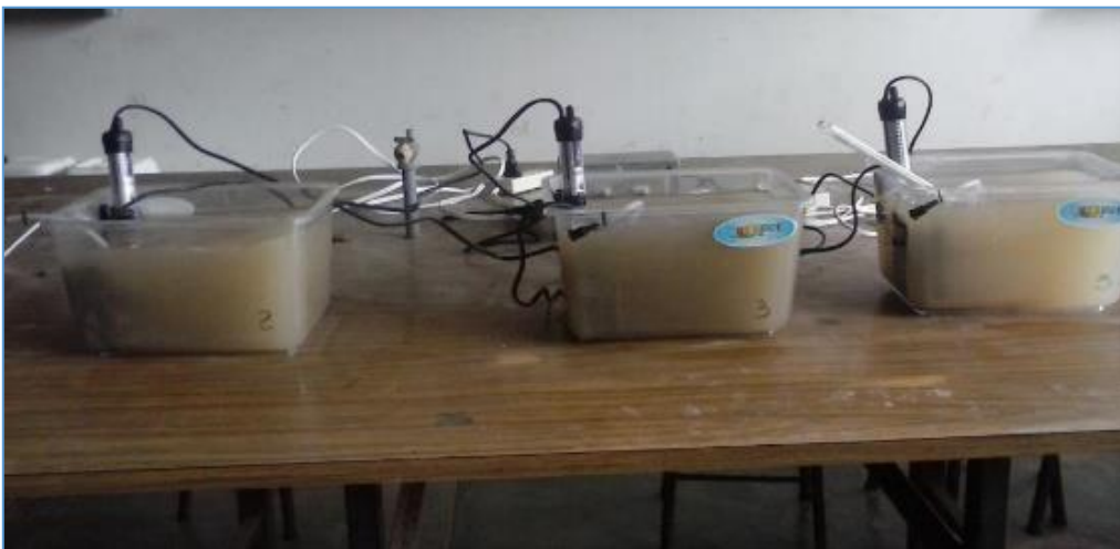
Figura 3. Acondicionamiento de consorcio de microorganismos extraídos del lodo activado a incubados a las temperaturas de 30 ° C
