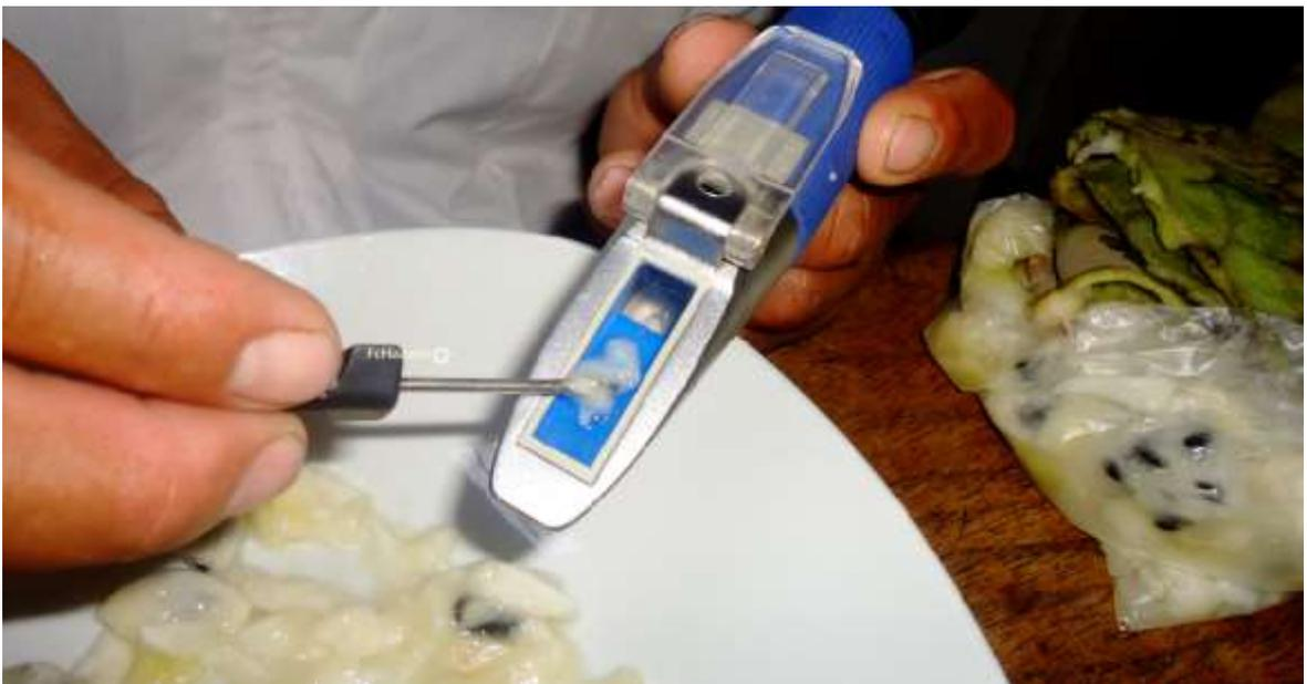
Figura 6. Determinación del grado brix total (%).
