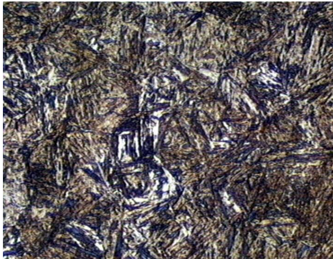
Figura 5. Fotomicrografía de la microestructura de martensita en un acero al carbono templado.
