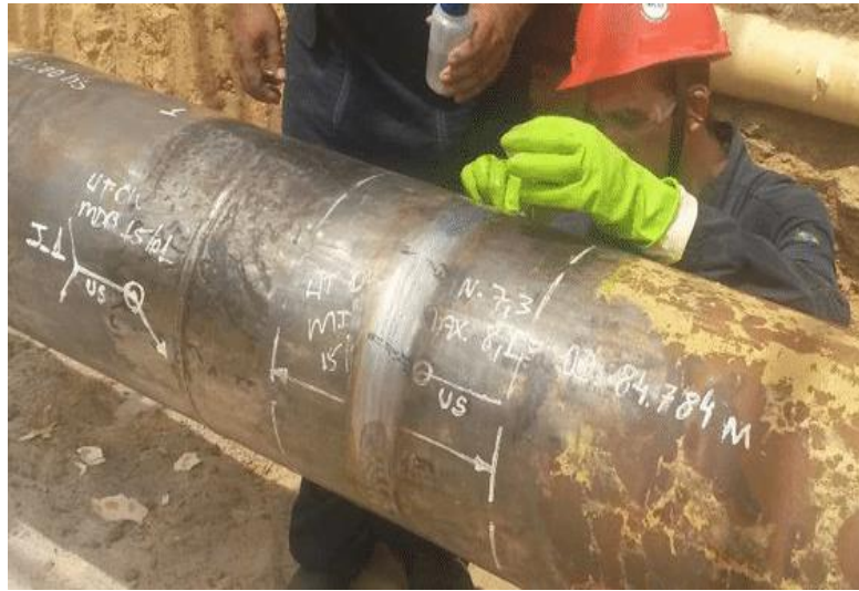
Figura 17. Ensayo mediante replicas metalográficas.
