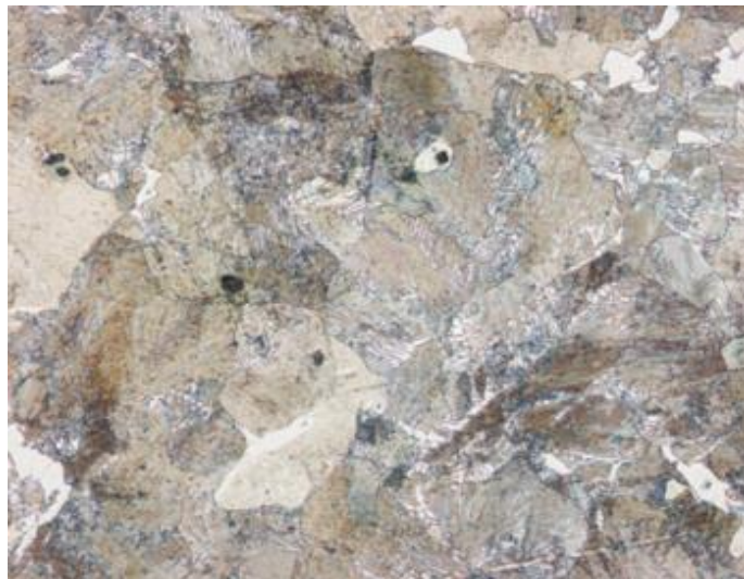
Figura 4. Fotomicrografía de la microestructura de perlita en un acero al carbono.
