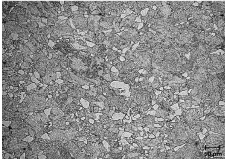
Figura 19. Microestructura en estado de suministro acero ASTM A335 grado P22.
