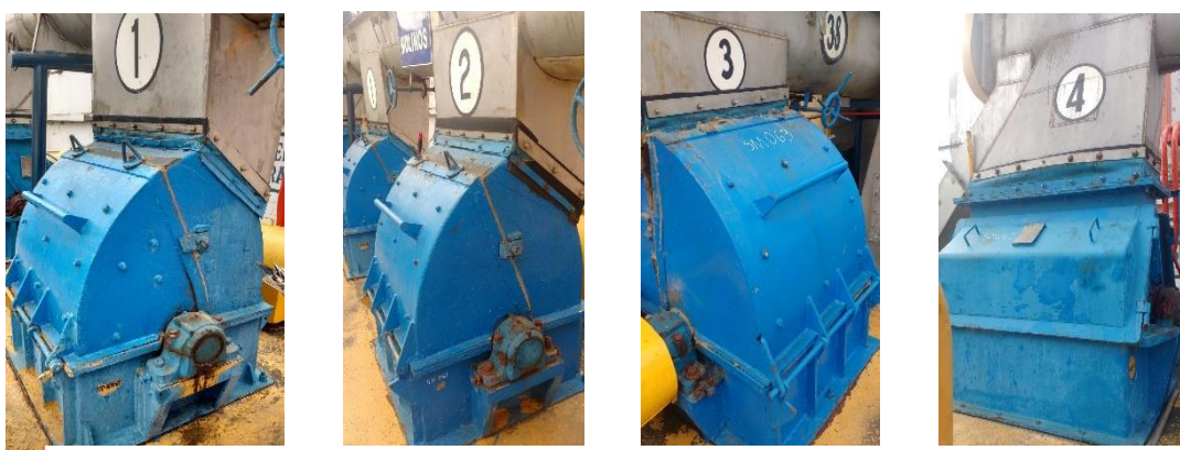
Figura 6: Equipo mezclador de antioxidante.
