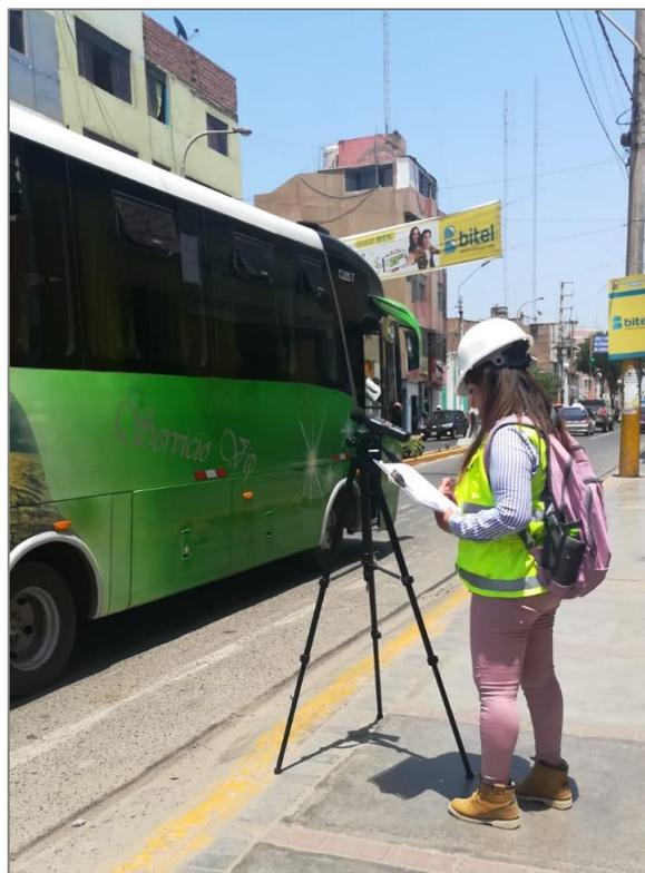
*Figura 33.* Monitoreo de ruido ambiental en la zona de protección especial (Barranca).
