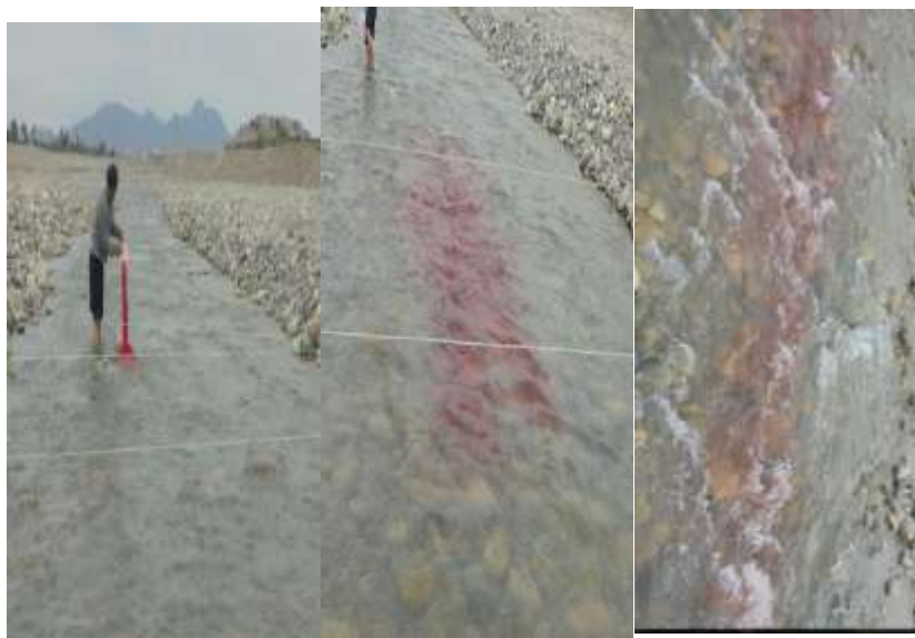
Figura 1: (a) vertido del soluto en el agua (b) y (c) desplazamiento del colorante por las secciones a analizar.
