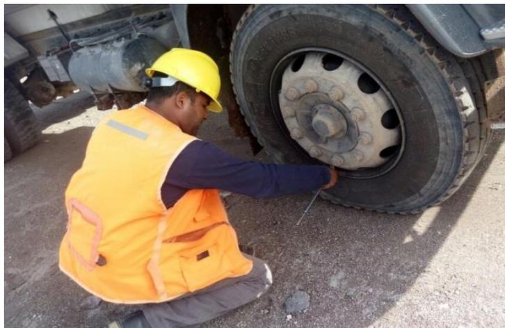
*Figura 10: Medición de la Presión de Inflado del neumático (llanta) para un camión de 2 ejes.*
