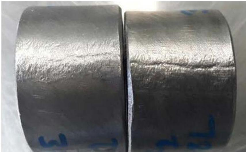
*Figura 20. Probetas soldadas – Ensayo de doblado de raíz.*
