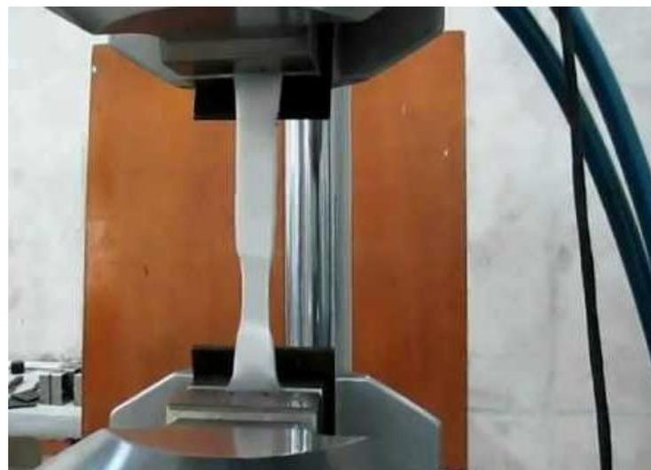
Figura 31. Ensayo de tracción probeta 1.
