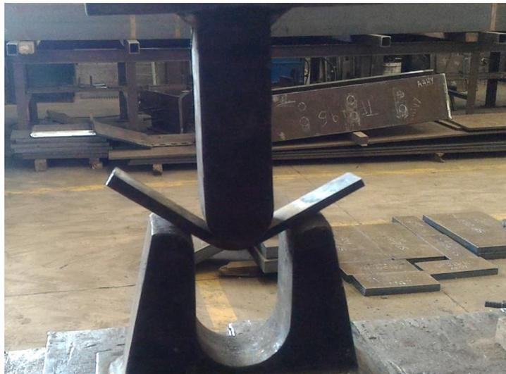
Figura 33. Ensayo de dobléz.
