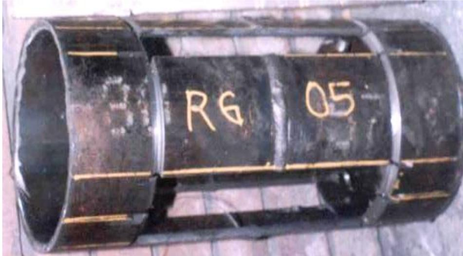
Figura 29. Extracción de probetas para ensayos mecánicos.
