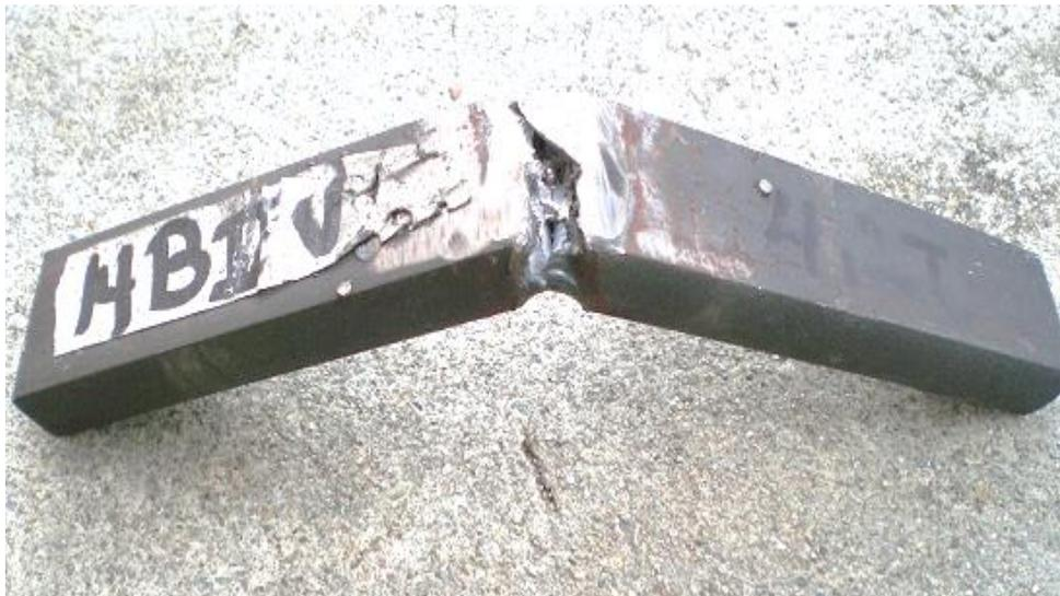
*Figura 18.* Probetas soldadas ensayadas por impacto.
