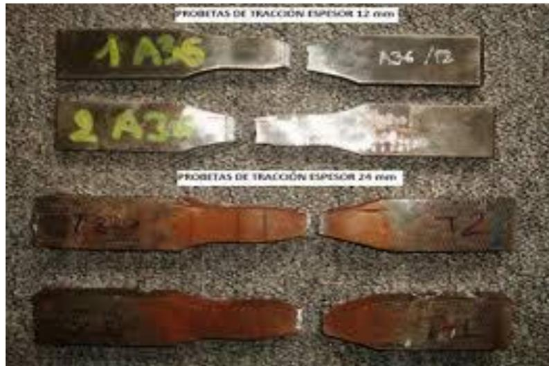
Figura 17. Probetas soldadas ensayadas por tracción.
