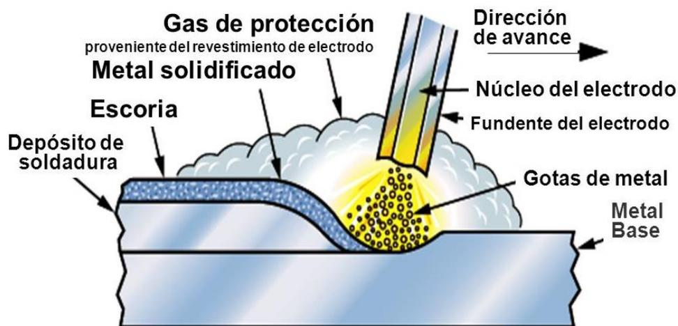
Figura 4. Esquema del proceso de soldadura SMAW.
