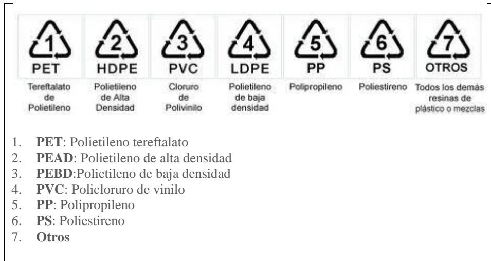
Figura 58. Códigos de identificación de resinas de plásticos.
