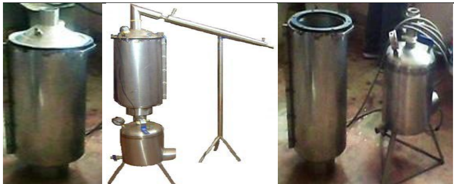
Figura 41. Equipo para extracción por arrastre de vapor utilizado.
