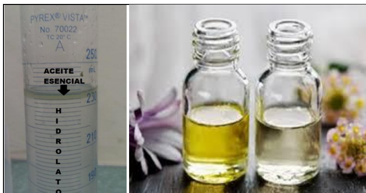
Figura 26. Mezcla heterogénea aceite esencial – hidrolato Fuente: Fotografía capturada por el autor (izquierda).
