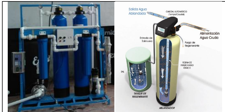
Figura 73. Módulo de ablandamiento de agua.
