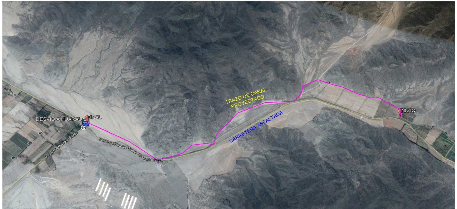
Figura N° 6: Canal de regadío Projectado.
