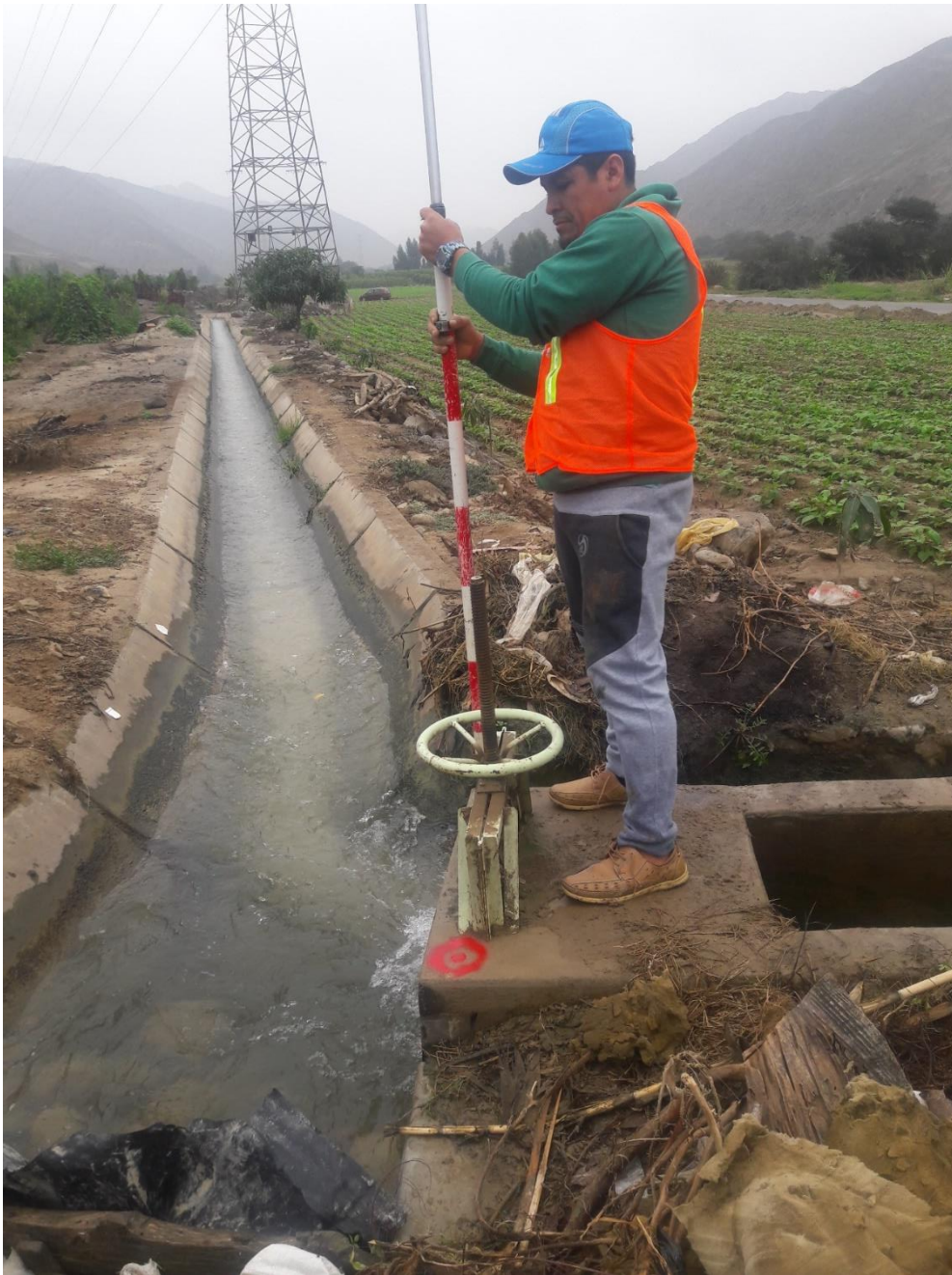
Figura N° 2: Levantamiento Topográfico de Compuertas existentes.
