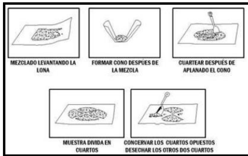
Figura 11. Selección de muestras por pilas cónicas
