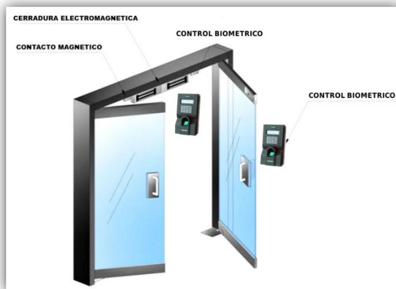
**Figura 2: Sistema de Control de Acceso**
