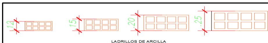
Figura 48: Detalle de ladrillo para techo de arcilla.
