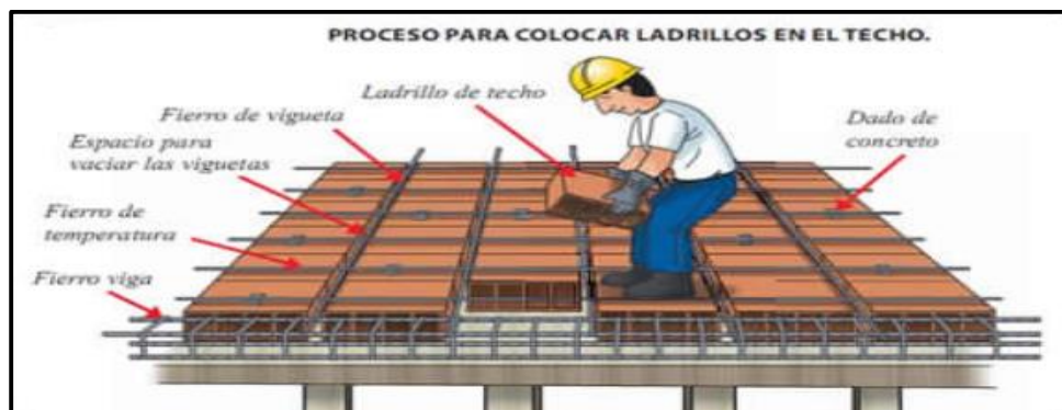
Figura 50: Detalle de colocación de los ladrillos de techo.
