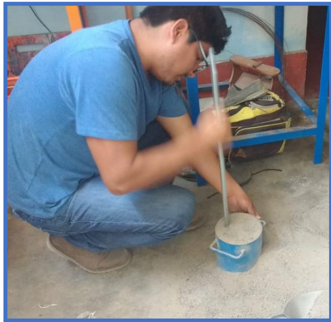
Figura 12: Compactación mediante golpe, con una varilla de metal
