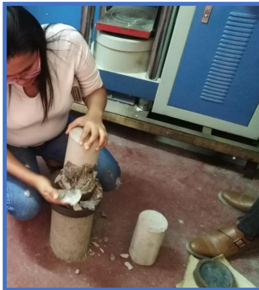
Figura 31: Rotura de Testigos a 14 días
