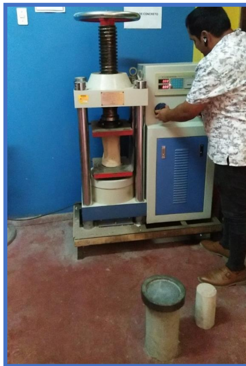
Figura 32: Colocación del Testigo para el Proceso de Compresión
