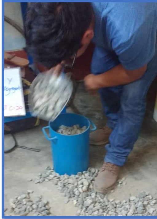
Figura 23: Llenado de la Segunda Capa de Agregado
