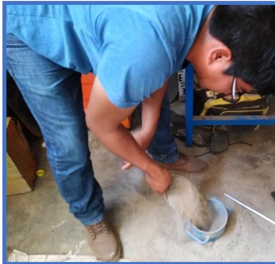
Figura 9: Llenado de agregado en el Recipiente
