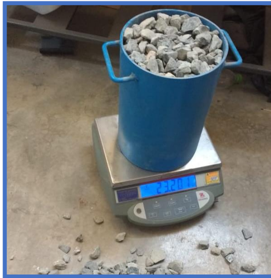
Figura 25: cálculo del recipiente con la muestra compactada
