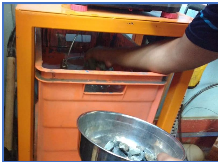
Figura 17:Ingresamos la Muestra a un recipiente Sumergido en Agua
