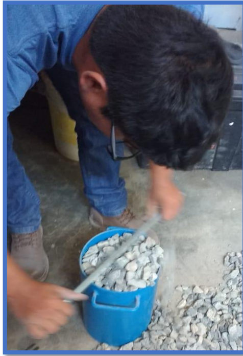
Figura 20: Eliminando el Exceso de Muestra
