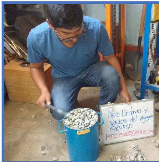
Figura 24: Recipiente con la muestra compactada
