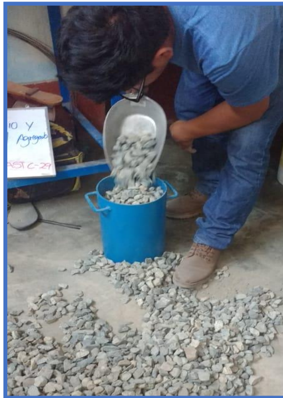
Figura 19: Llenado del Agregado Grueso en el Recipiente
