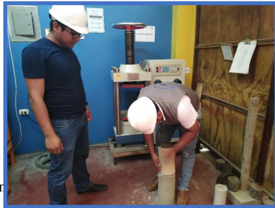
Figura 29: Colocación del testigo para proceso de compresión.
