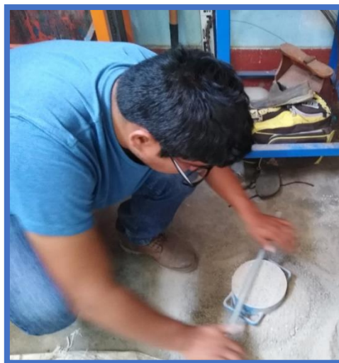
Figura 10; Eliminación el exceso de Material
