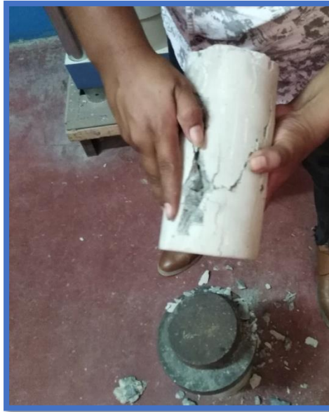
Figura 33: Rotura de Testigo a 28
