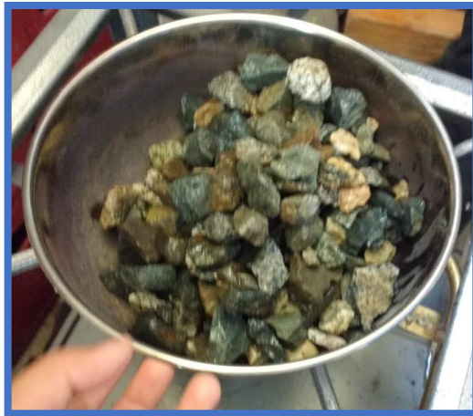
Figura 16: Extracción de la Humedad del Agregado
