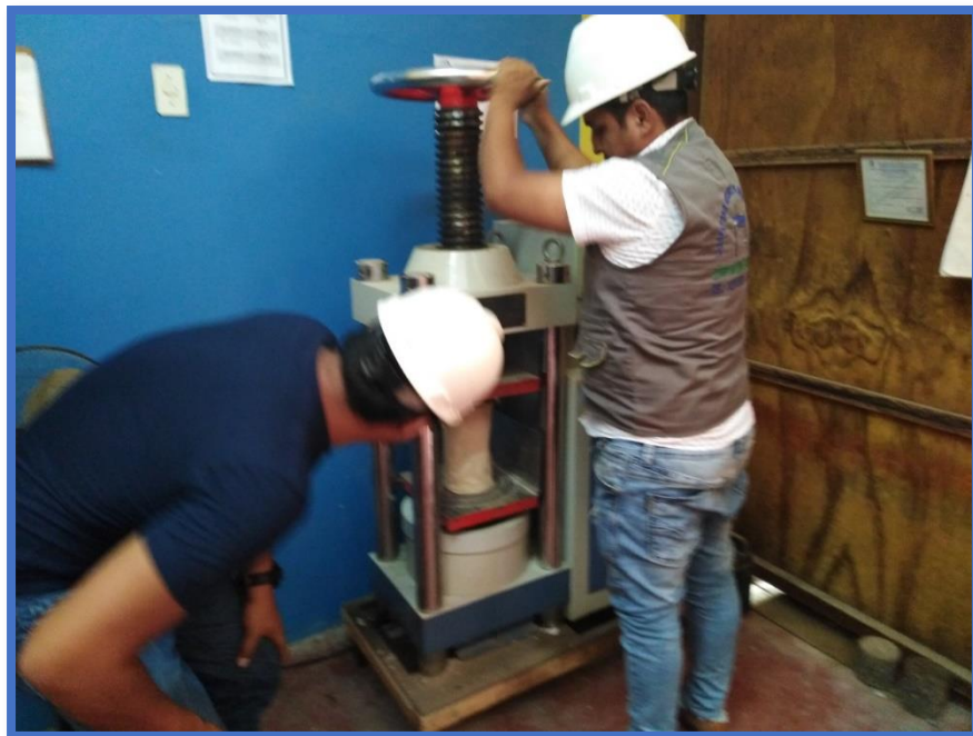
Figura 29: Colocación del testigo para proceso de compresión.
