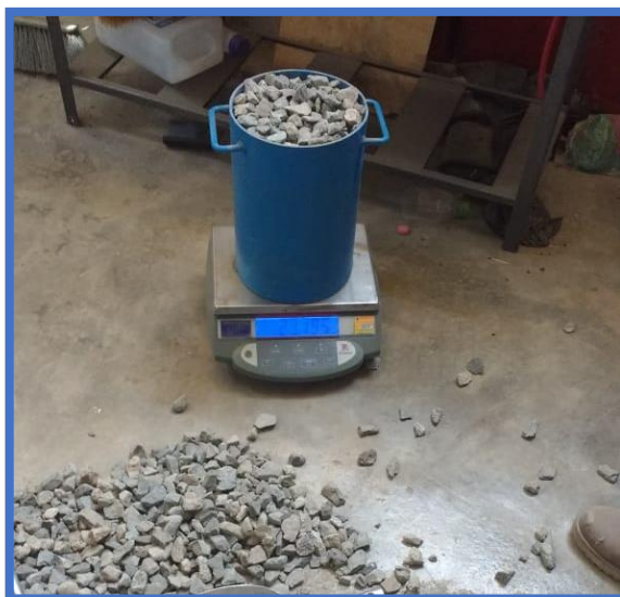
Figura 21: Calculo del Peso del Recipiente + la Muestra
