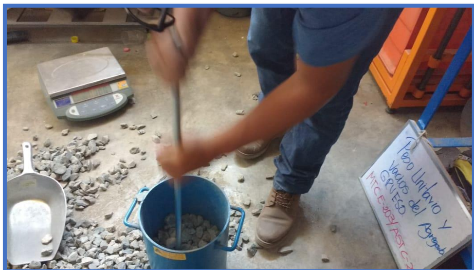
Figura 22: Compactación con la Varilla en la Primera Capa de Agregado
