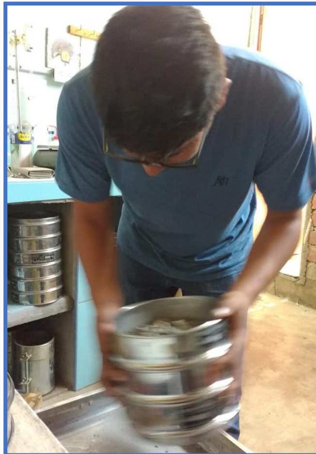
Figura 14: Tamizaje de Agregado Grueso
