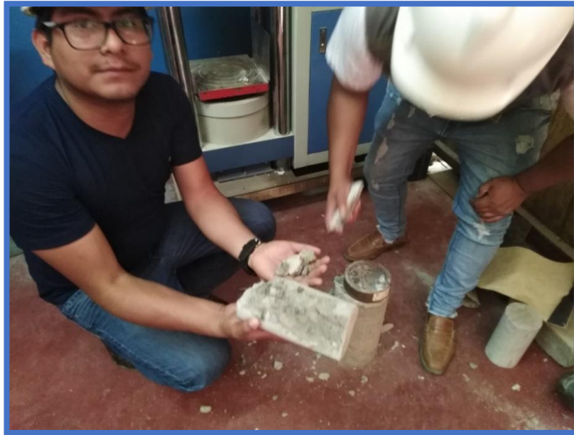
Figura 30: Rotura de Testigo a 7 días
