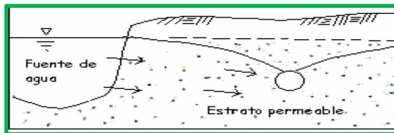
Figura 7: Galería con escurrimiento propio y recarga superficial
