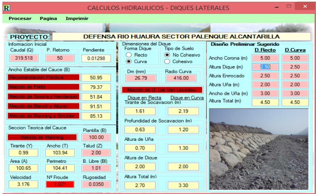
Figura 13: Cálculos hidráulicos diques laterales
