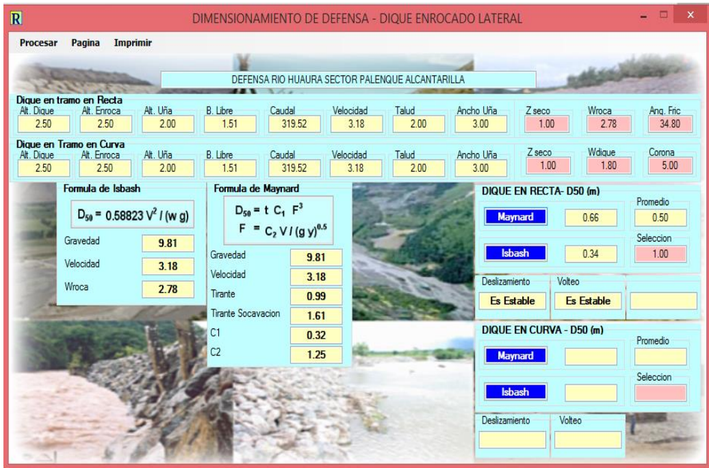
Figura 14: Dimensionamiento de defensa - tramo recto
