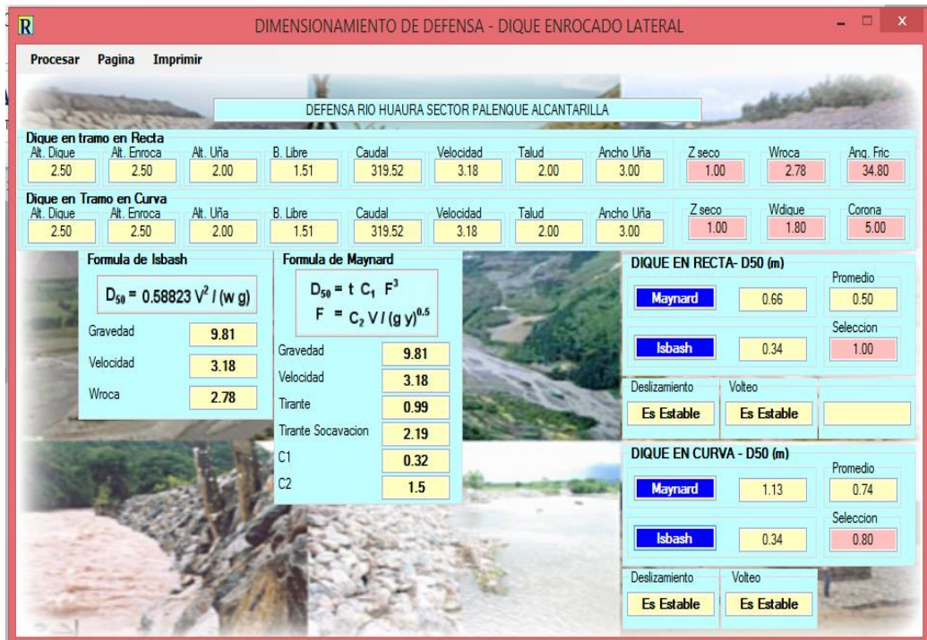
Figura 16: Dimensionamiento de defensa - tramo curva
