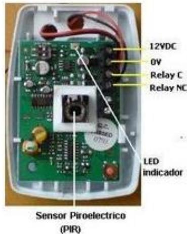
*Figura 7: Detector de movimiento pasivo PIR
