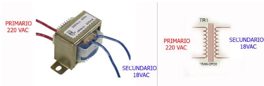
*Figura 23: Transformador monofásico
