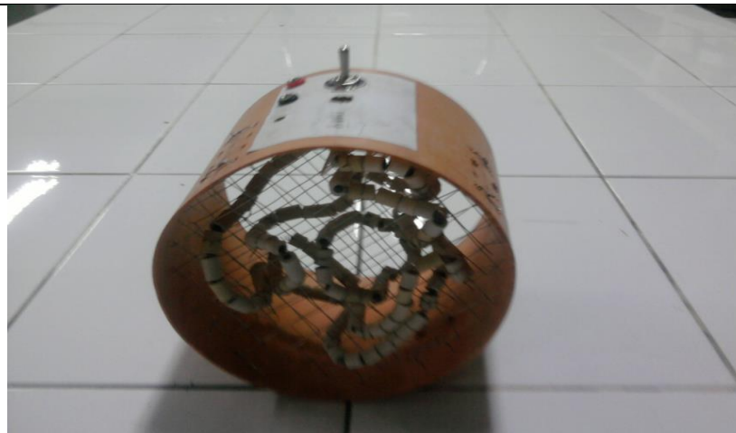
Figura N° 08: Fotografía del sistema de calefacción de aire, construido en el laboratorio de Física I de la UNJFSC.
