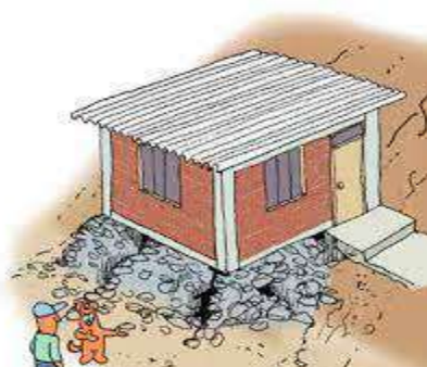
Figura 2: Base de vivienda construida por pircas
