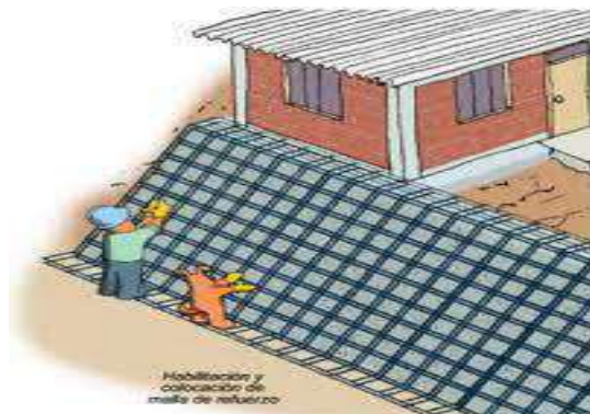
Figura 3: viviendas en laderas, reforzado con mallas
