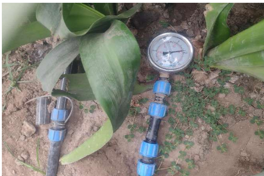
Figura 12. Medición de presiones con manómetro.
