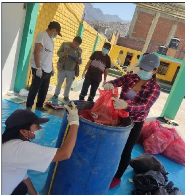
Figura 38. Medición de la altura del cilindro para determinar la densidad.
