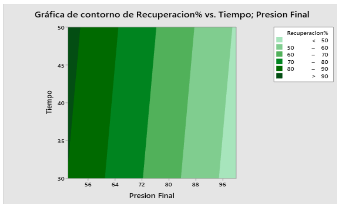
Figura 10: Gráfico de contorno de la recuperación de oro en función de la presión
