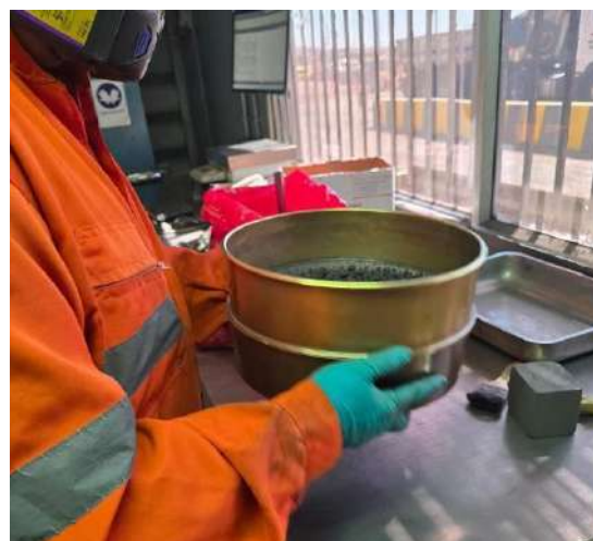
Foto 6: Tamizado de material
