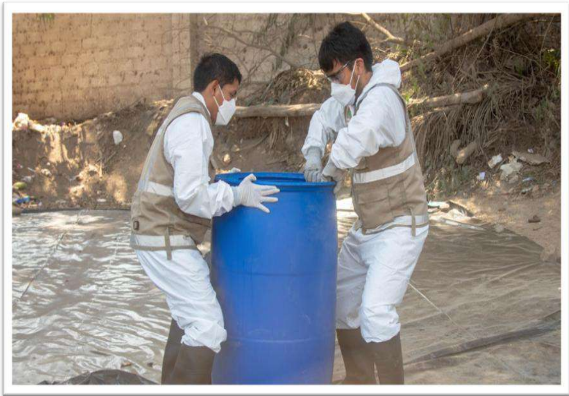
Figura 49. Medición de la densidad de residuos en Sayán. Elaboración propia.
