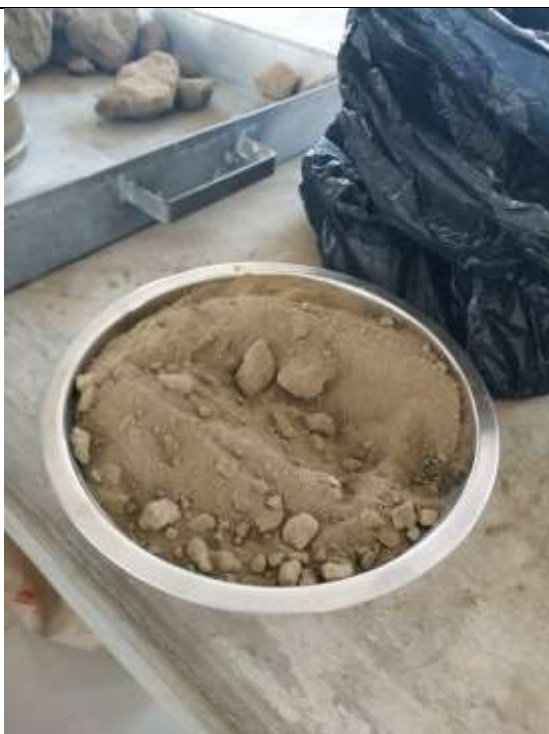
Figura 8. Muestra para el ensayo de granulometría
