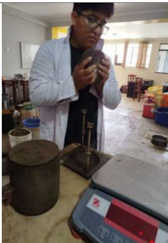
Figura 23. Muestra del ensayo del Proctor e identificación de la humedad óptima
