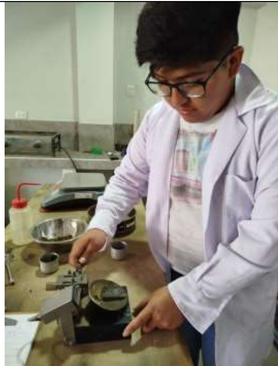
Figura 35. Se realiza el ensayo de Limite Plástico
