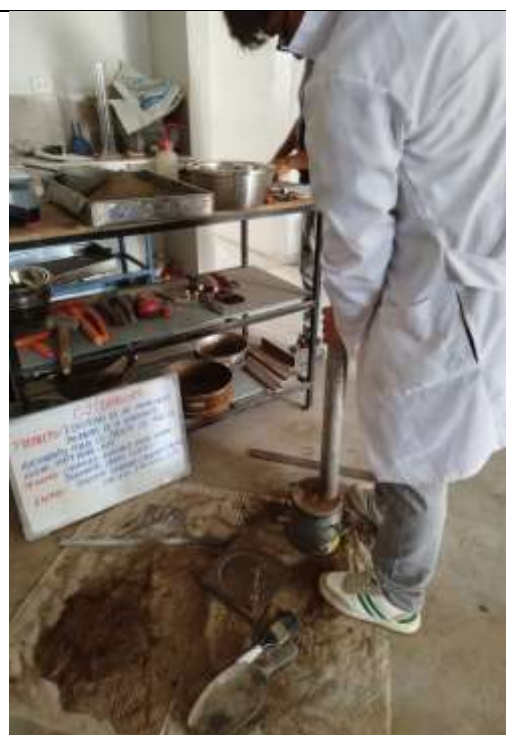
Figura 17. Compactación de la muestra para el ensayo del Proctor Modificado C-2
