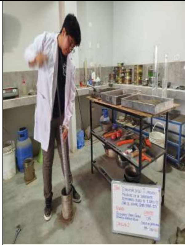
Figura 39. Compactación de la muestra por el ensayo del Proctor Modificado/CBR
