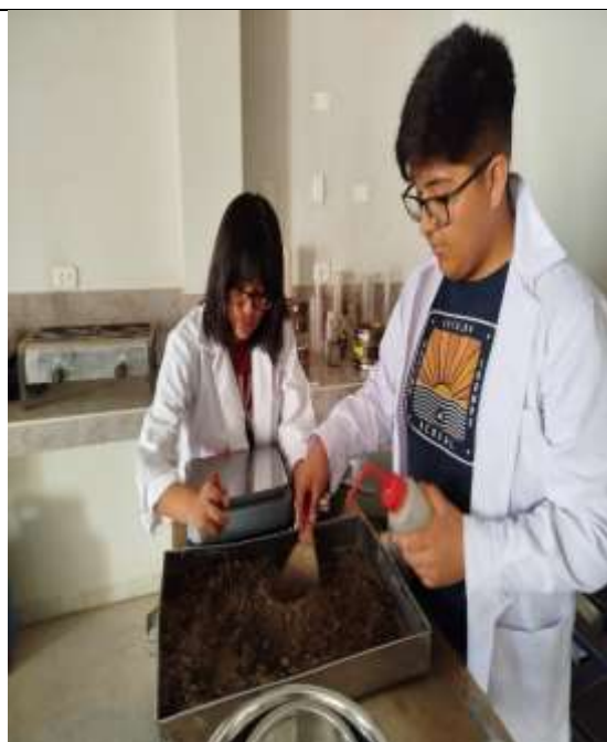
Figura 15. Toma de Muestra para el ensayo del Proctor modificado C-2
