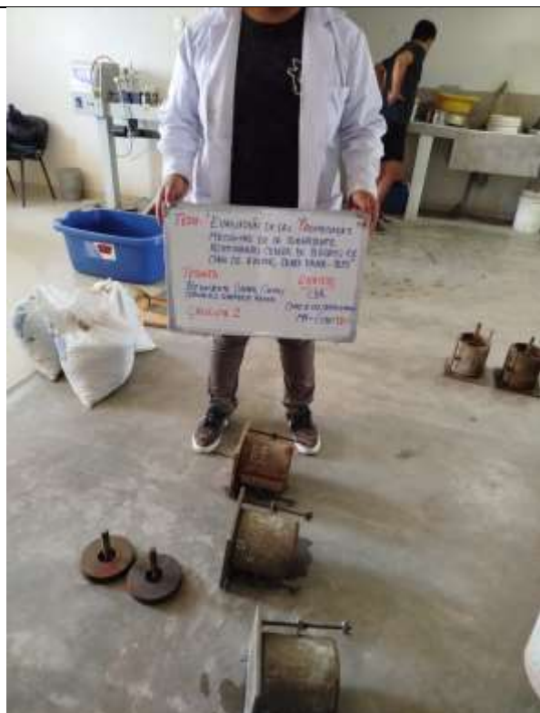
Figura 48 Extracción de la muestra después de 7 días de +13% CBCA.
