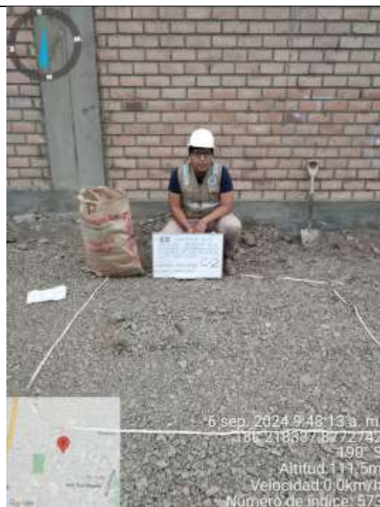
Figura 7. Extracción de las muestras de las respectivas calicatas C-2
