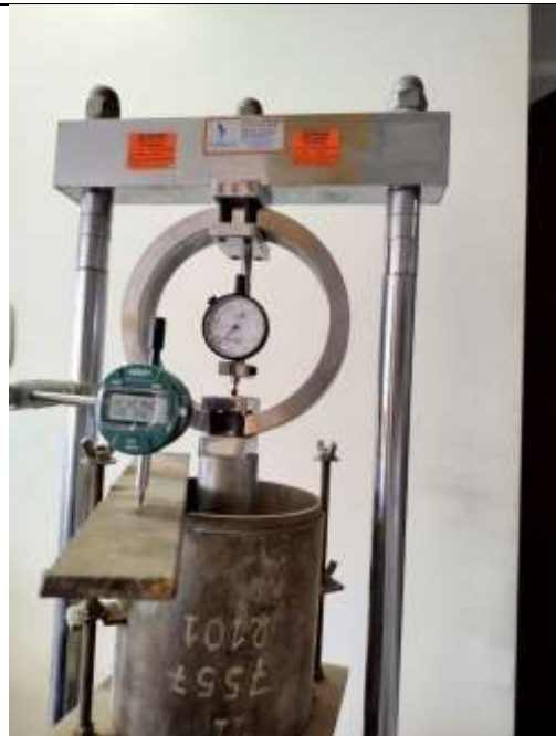
Figura 27. Posterior a los 7 días se toma los datos aplicando cargas
