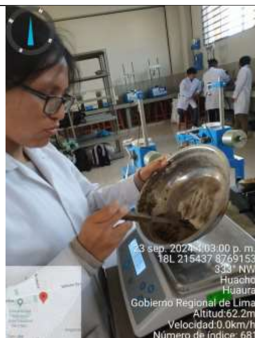
Figura 13. Adición de agua a la muestra para el ensayo de LL.
