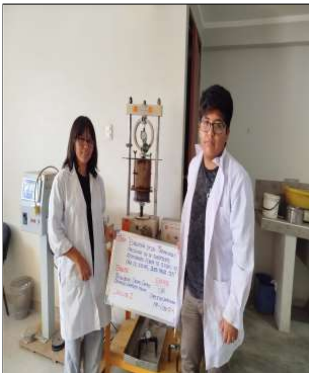
Figura 50 Ensayo del CBR con 7% CBCA
