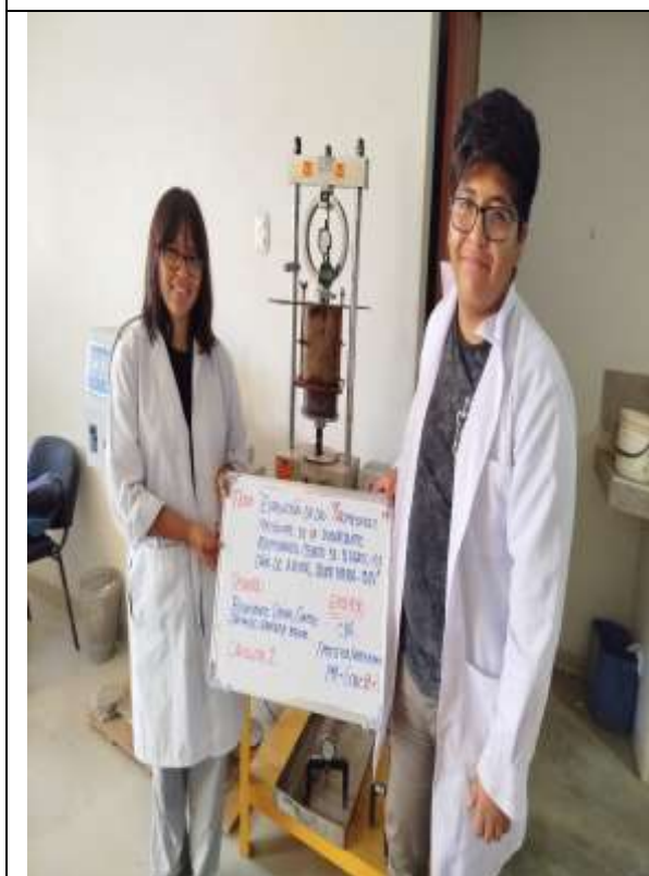
Figura 52 Ensayo del CBR con 13% CBCA
