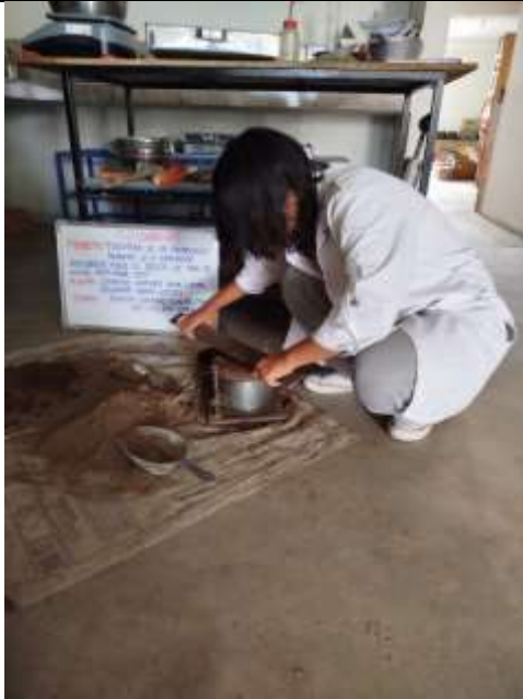
Figura 18. Perfilado de la muestra para el ensayo del Proctor Modificado
