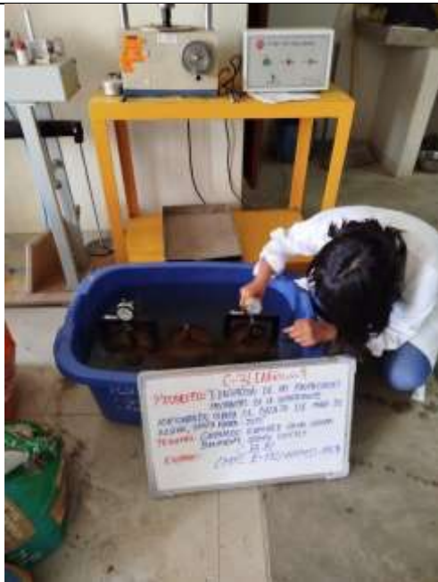
Figura 26. Sumergido de la muestra y poniendo el dial para medir la deformación
