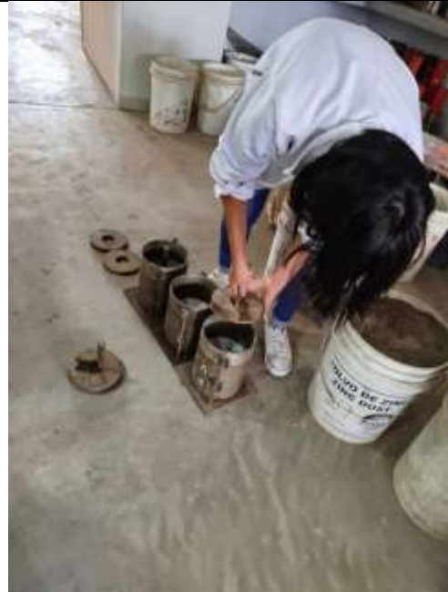
Figura 19. Sellado de la muestra antes de sumergirlo en agua
