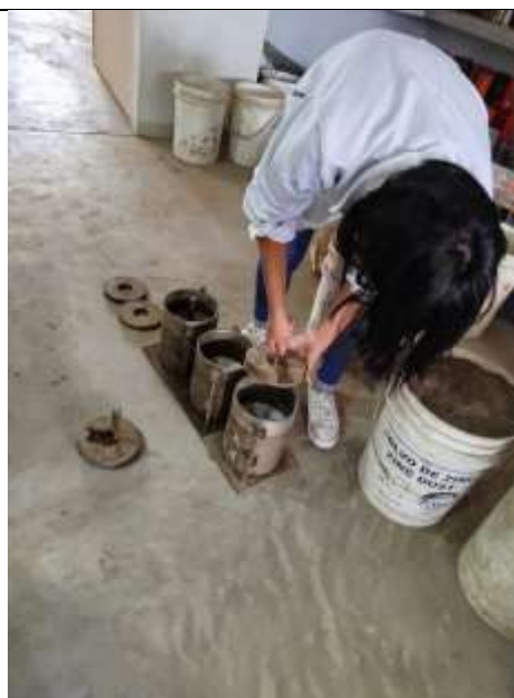
Figura 25. Muestras para el Ensayo del CBR de la C-2
