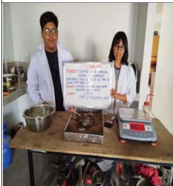
Figura 24. Muestra para el Ensayo del CBR de la C-2
