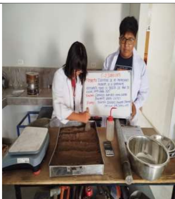
Figura 16. Cuarteo de la Muestra para el ensayo del Proctor modificado C-2
