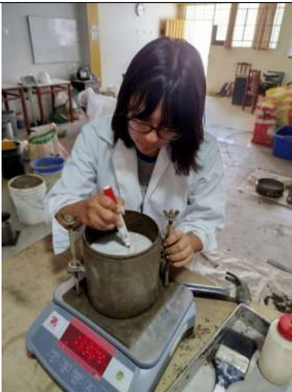
Figura 20. Toma e Identificación de la muestra antes de sumergirlo
