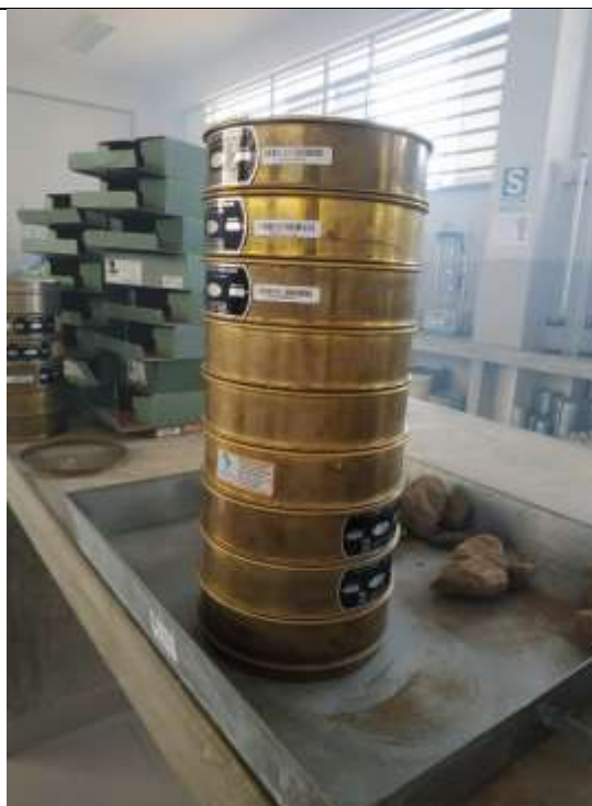
Figura 9. Selección de los tamices para el ensayo
