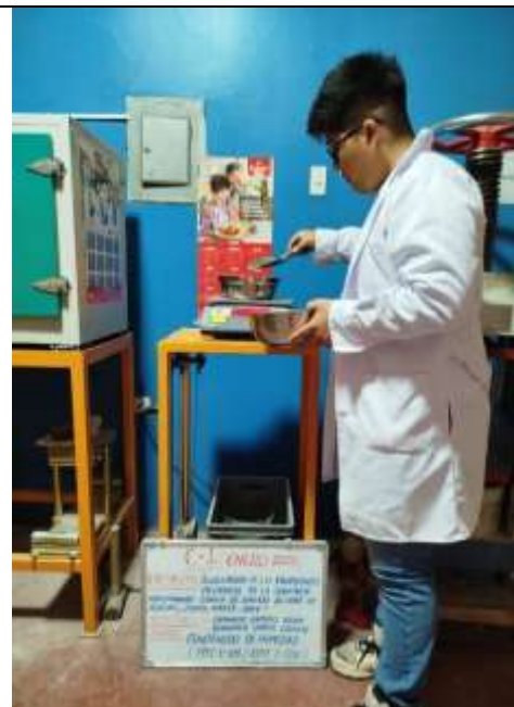
Figura 37. Ensayo de Contenido de Humedad
