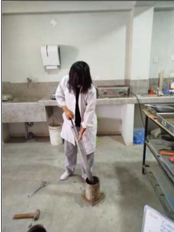
Figura 38. Compactación de la muestra por el ensayo del Proctor Modificado/CBR
