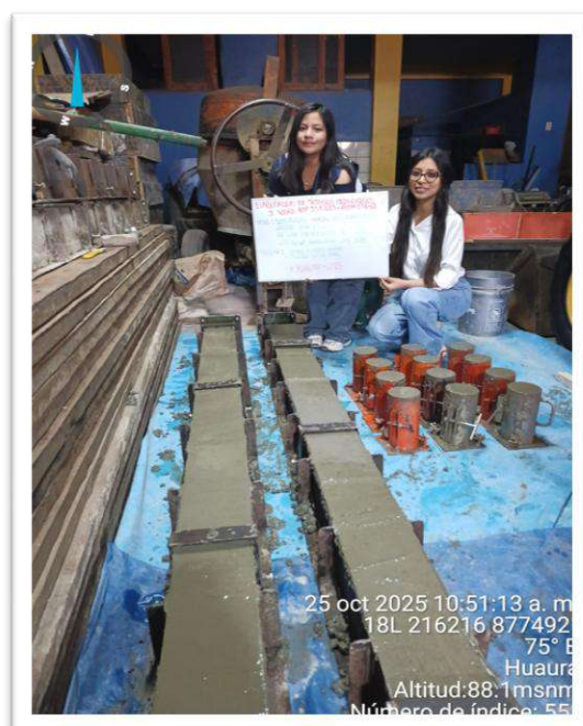
Imagen N°10 : Elaboración De Testigos Cilíndricos Y De Vigas (NTP 339.033 – ASTM C78 - 02)
