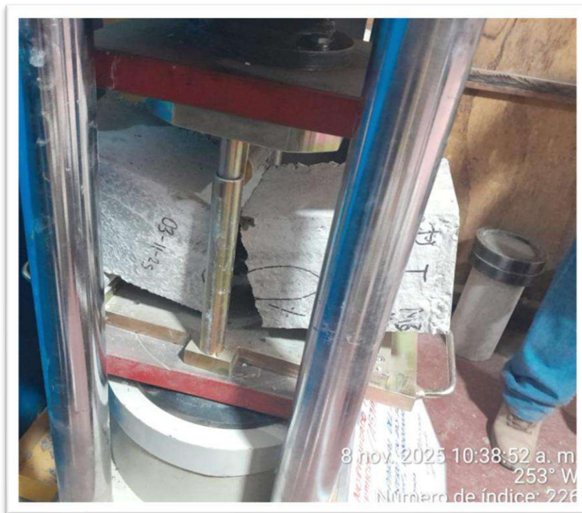
Imagen N° 13: Ensayo de flexión en vigas (7 días)
