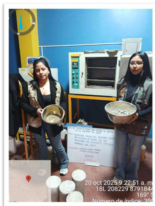
Imagen N.º 4: Evaluación del contenido de humedad en agregados (MTC E-215).
