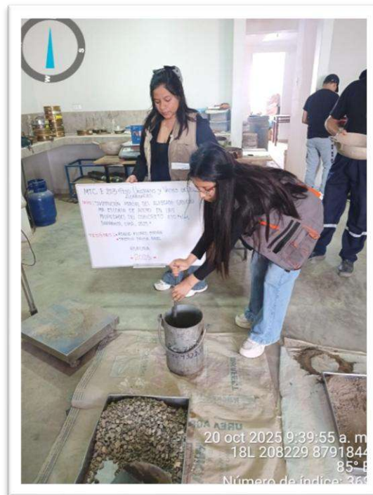
Imagen N.º 5: Evaluación de peso unitario y vacíos de agregados (MTC E-203).
